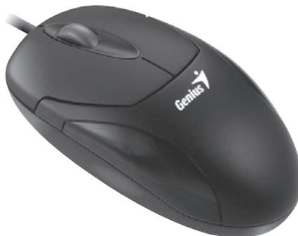
► **Figura 7.** En la actualidad, el mouse tradicional ha sido reemplazado por el **mouse óptico**, que utiliza un láser para detectar el movimiento.
