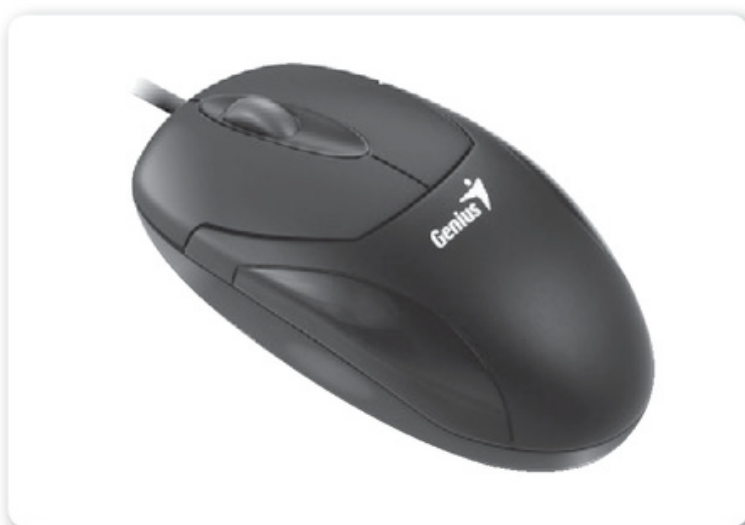
► Figura 7. En la actualidad, el mouse tradicional ha sido reemplazado por el mouse óptico , que utiliza un láser para detectar el movimiento.
