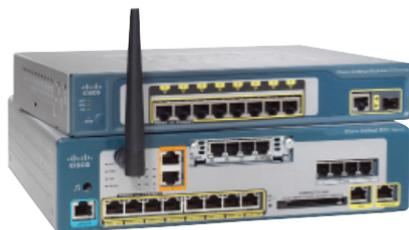
**Figura 11.** La UC 500 es una centralita para pymes de CISCO que soporta de 8 a 104 usuarios.
