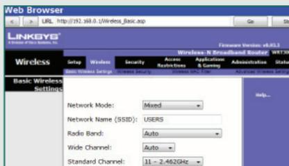
Vaya al campo **Standard Channel**, despliegue el menú y seleccione algunos de los canales presentes en la configuración. Guarde la información pulsando el botón **Save Settings**. Cierre el asistente de configuración.
