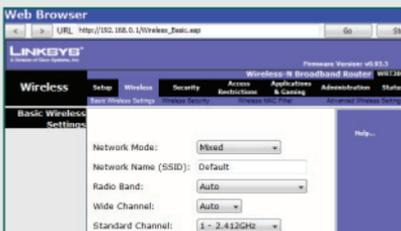
Se abrirá la consola de configuración (GUI) del router desde la PC utilizada. Desde la interfaz diríjase a la pestaña **Wireless**.
