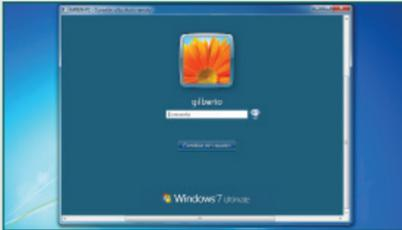
Una vez que se establece la conexión, aparece una nueva ventana que solicita la **clave** del equipo anfitrión. Ingrésela y pulse **Aceptar**. Se abrirá el escritorio del equipo remoto.
