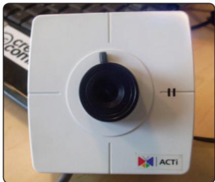
**Figura 6.** Las cámaras IP utilizan el protocolo de Internet para funcionar en la red.
