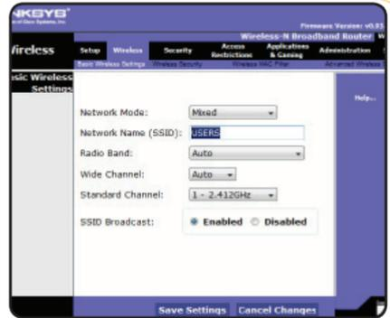
**Figura 8.** Cambiar el SSID por defecto de un dispositivo de red inalámbrico garantiza mayor seguridad.
