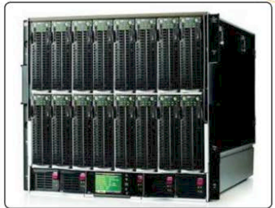
Figura 11. Un enclosure contiene todos los servidores blade, compartiendo energía, refrigeración y otras conexiones.
