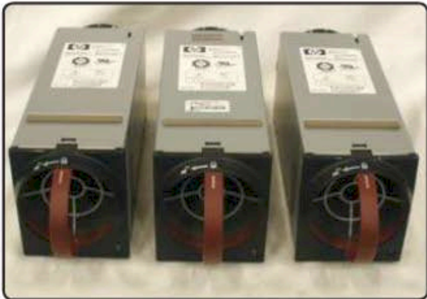
Figura 12. Cada dispositivo del enclosure es hot swap, esto quiere decir que se puede cambiar mientras está encendido el cajón.
