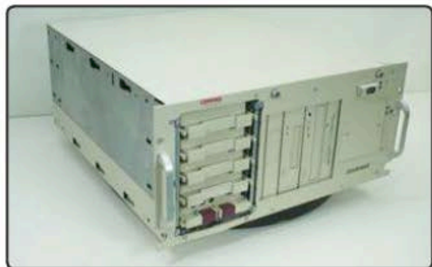
Figura 7. Uno de los primeros servidores físicos x86 que reemplazaron a los mainframes.
