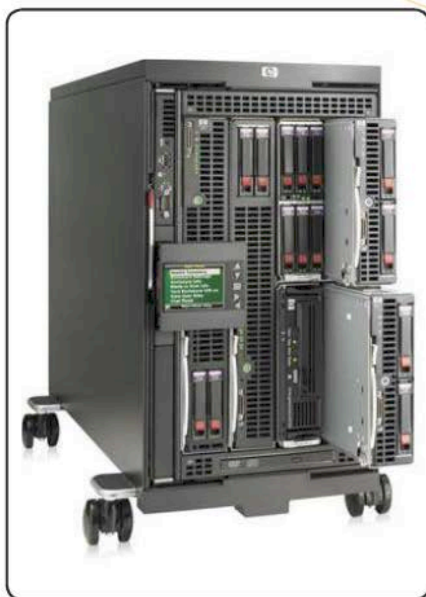
Figura 4. Los cajones blade de HP son increíbles; permiten sacar y cambiar casi cualquier componente en caliente.
