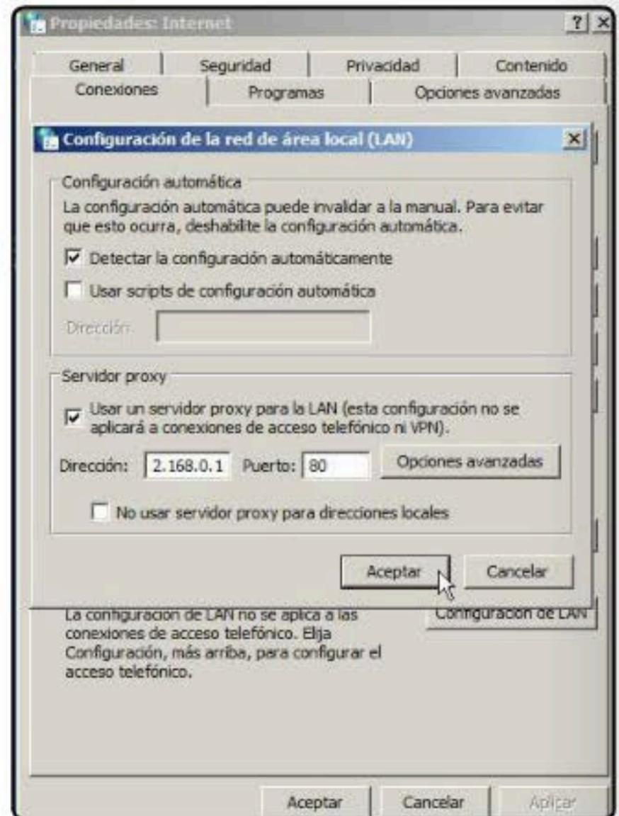
**Figura 3.** Las aplicaciones de los equipos cliente deben ser configuradas especialmente para realizar sus solicitudes al servidor proxy.
