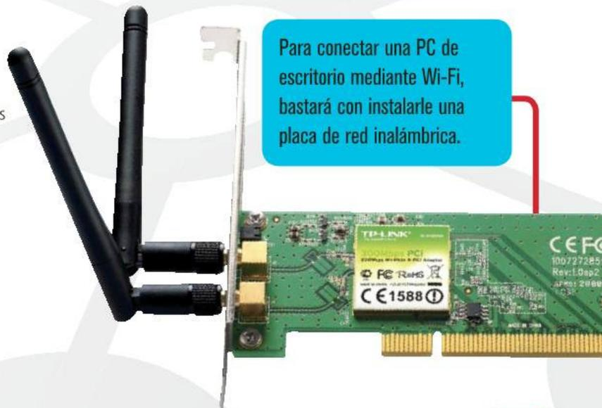
Para conectar una PC de escritorio mediante Wi-Fi, bastará con instalarle una placa de red inalámbrica.
