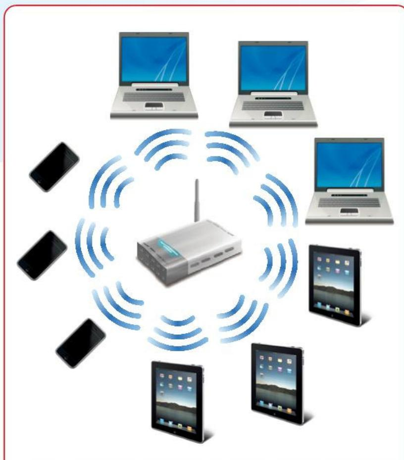
En este diagrama, podemos apreciar cómo, en la topología de infraestructura, los dispositivos se concentran en el router Wi-Fi.
