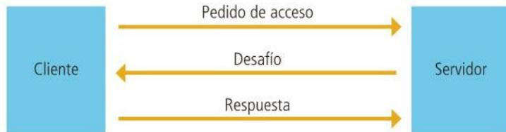
En este diagrama, se presenta el proceso de desafío respuesta entre un servidor de autenticación y el cliente conectado.
