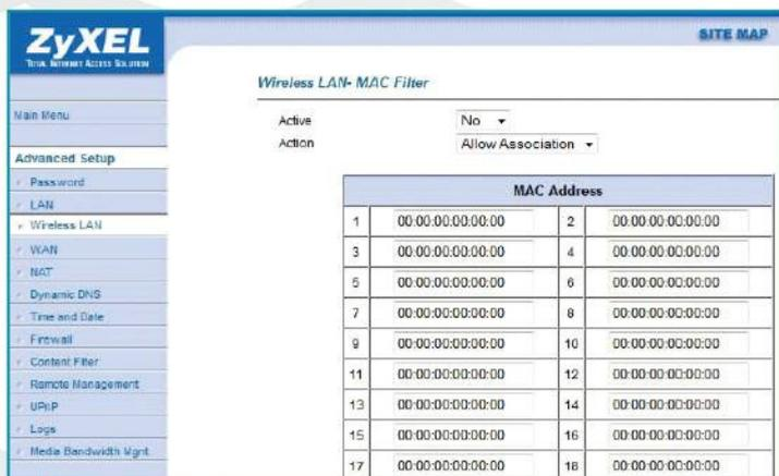
Este modelo de módem/router nos permite realizar el filtrado de hasta 32 MAC Address en total.
