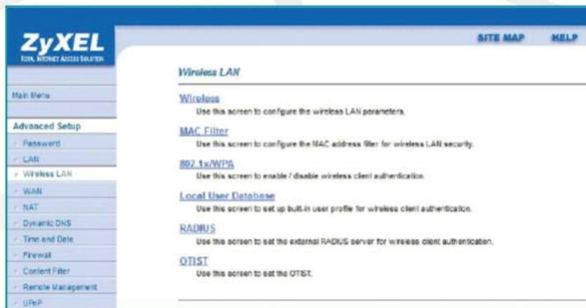
Desde la pantalla **Wireless LAN**, podemos configurar los filtros de acceso, por ejemplo, utilizando las direcciones MAC.
