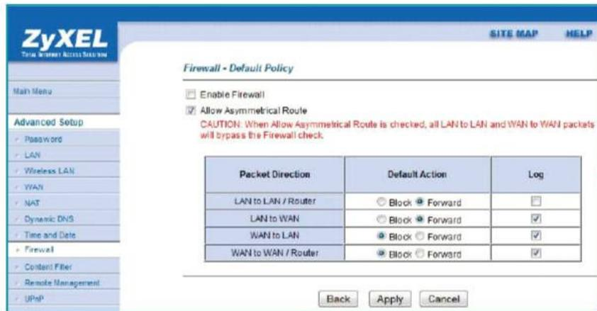
Para habilitar el firewall, debemos ingresar en la pantalla que vemos en la imagen y activar el servicio. Las reglas se configuran en otro apartado.
