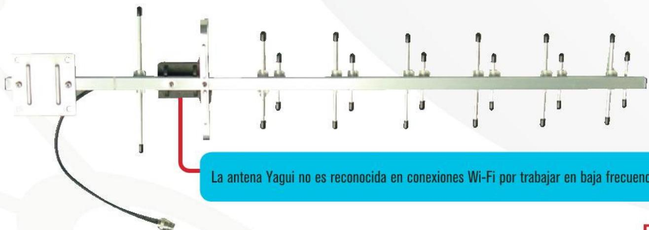
La antena Yagui no es reconocida en conexiones Wi-Fi por trabajar en baja frecuencia.
