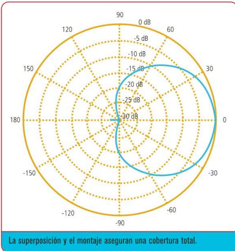
Los diseños típicos son de 90° y 120°, de modo que con tres o cuatro antenas completamos la cobertura total. A menudo, tiene unos grados extras para asegurar la superposición y el montaje. Existen modelos de antenas que ajustan su grado de cobertura, lo cual nos da el beneficio de la escalabilidad. Podemos empezar con tres antenas ajustadas a 120° y, con el tiempo, sumar otras hasta duplicarlas. Sus ventajas son:
