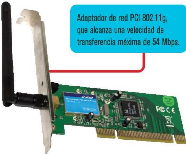
Adaptador de red PCI 802.11g, que alcanza una velocidad de transferencia máxima de 54 Mbps.
