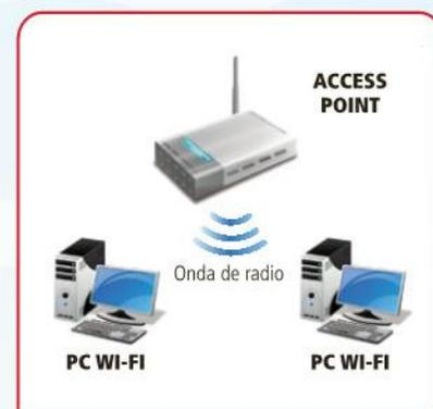
En la red de infraestructura (BSS), las interconexiones requieren de un Access Point.
