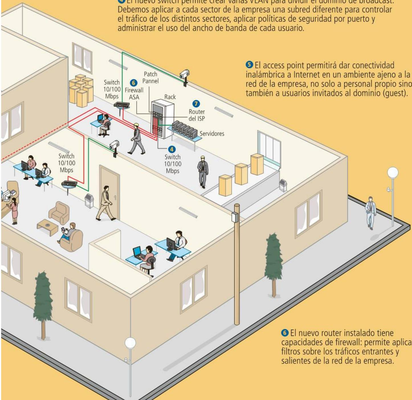
6 El nuevo router instalado tiene capacidades de firewall: permite aplicar filtros sobre los tráficos entrantes y salientes de la red de la empresa.
