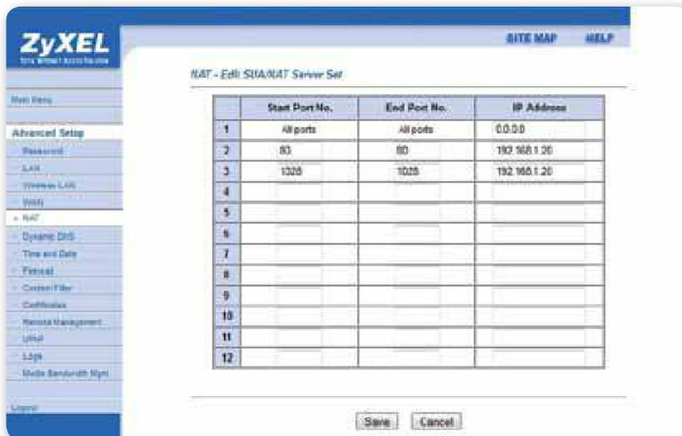
**Figura 16.** Podemos configurar el direccionamiento de puertos no solo para ver la cámara, sino incluso para otros servicios, como **Escritorio Remoto, streaming de video**, etcétera.
