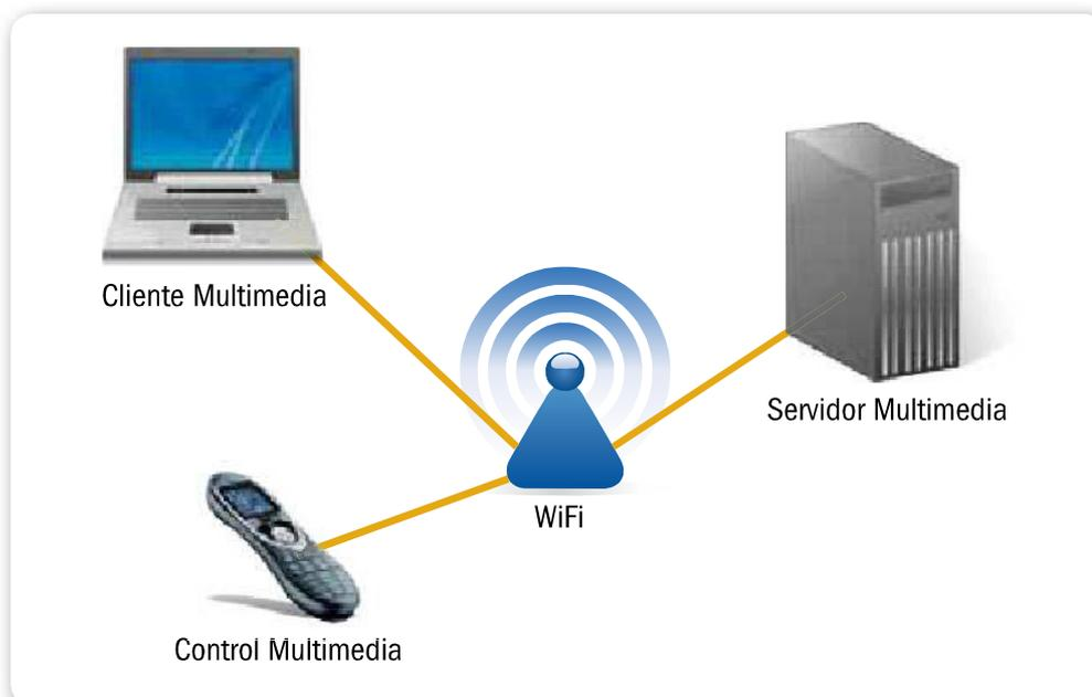
**Figura 20.** UPnP permite la interacción entre dispositivos presentes en una red hogareña sin la necesidad de una configuración previa.
