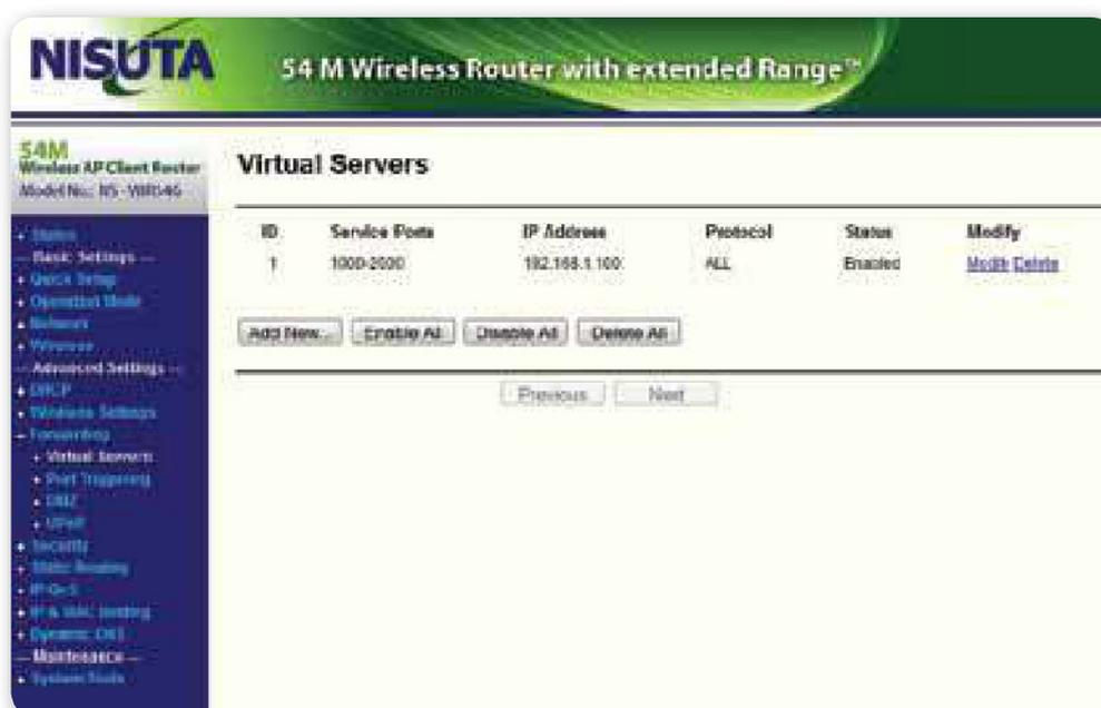
**Figura 16.** Tendremos un listado a modo de tabla con todos los equipos asignados a cada puerto para poder gestionarlos.
