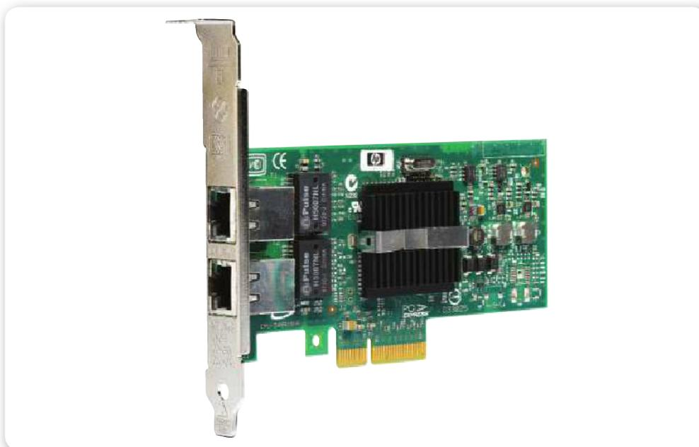
**Figura 1.** Las **placas de red** con varios puertos suelen ser utilizadas en servidores.
