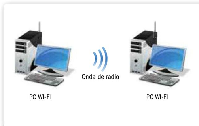
**Figura 1.** Esquema de **red ad hoc (IBSS)**:
