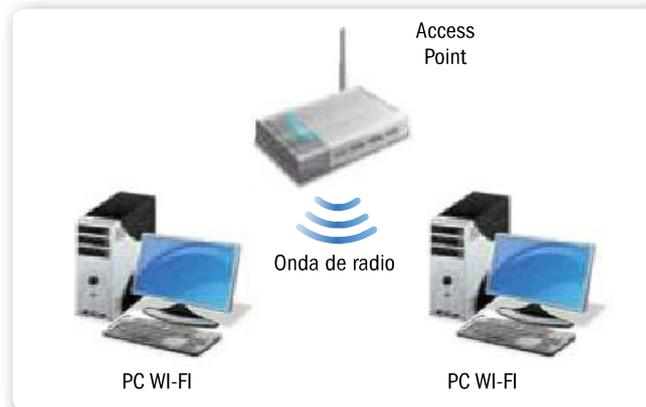
**Figura 2.** Esquema de **red de infraestructura (BSS)**, en la que las interconexiones entre los dispositivos se realizan mediante el access point.
