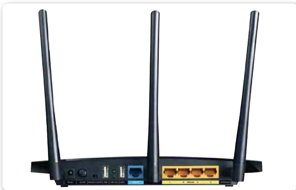
**Figura 8.** Los routers utilizan los puertos WAN para interconectarse con internet y redirigir los paquetes de datos.
