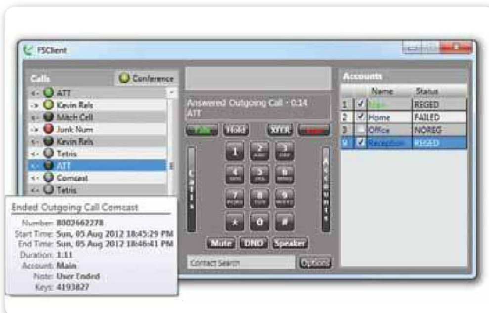
**Figura 11.** FSClient es un cliente SIP que corre sobre Windows. Se integra con FreeSWITCH. Soporta libreta de contactos interna y externa.
