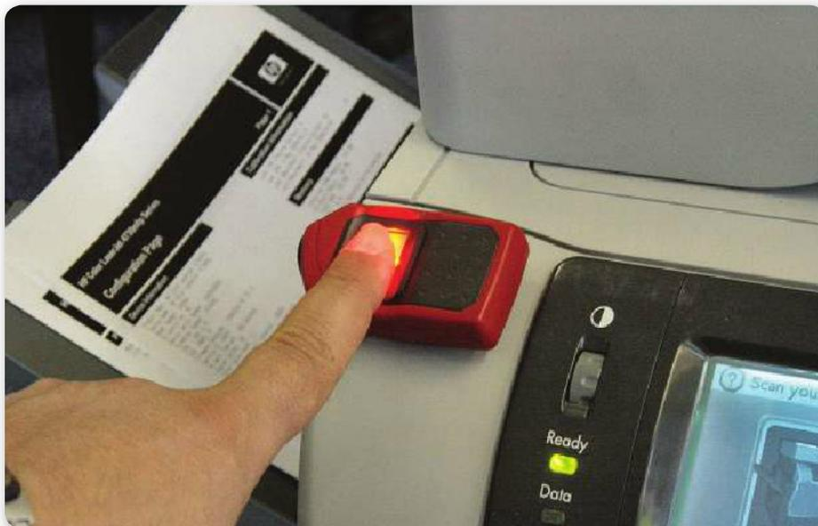
**Figura 17.** Autenticación biométrica para impresoras **HP LaserJet**. Permite limitar el uso del dispositivo a usuarios habilitados.
