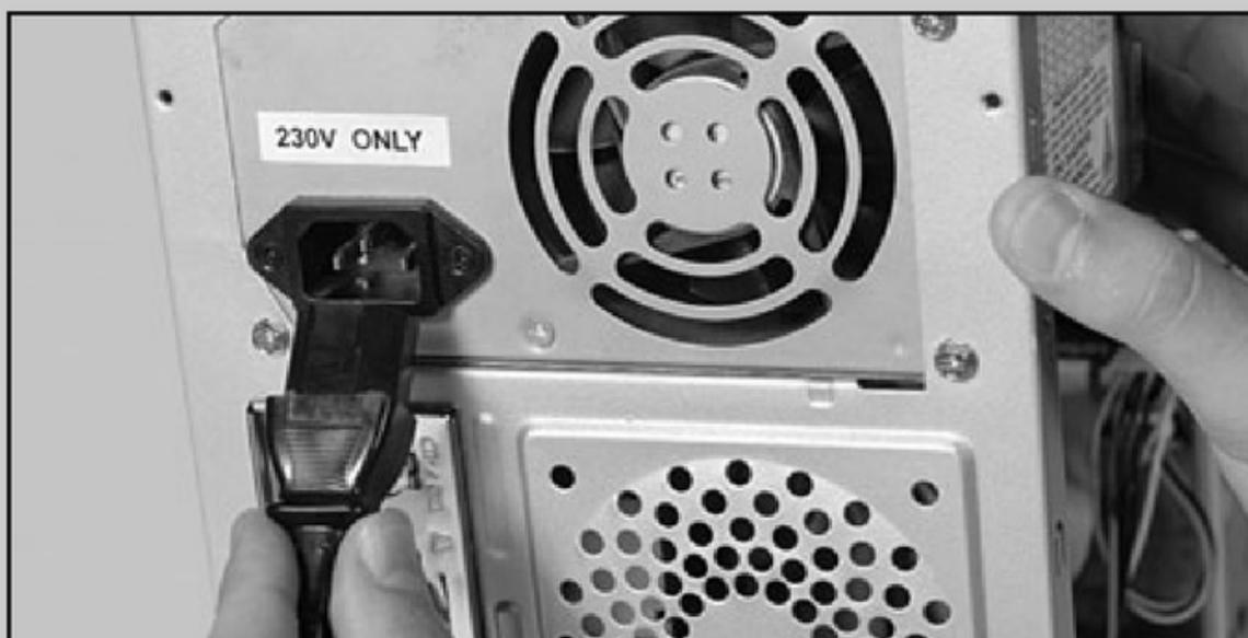
Lo primero que se debe hacer al instalar una tarjeta de red es desconectar la PC del enchufe eléctrico, para que el procedimiento se efectúe de manera segura.
