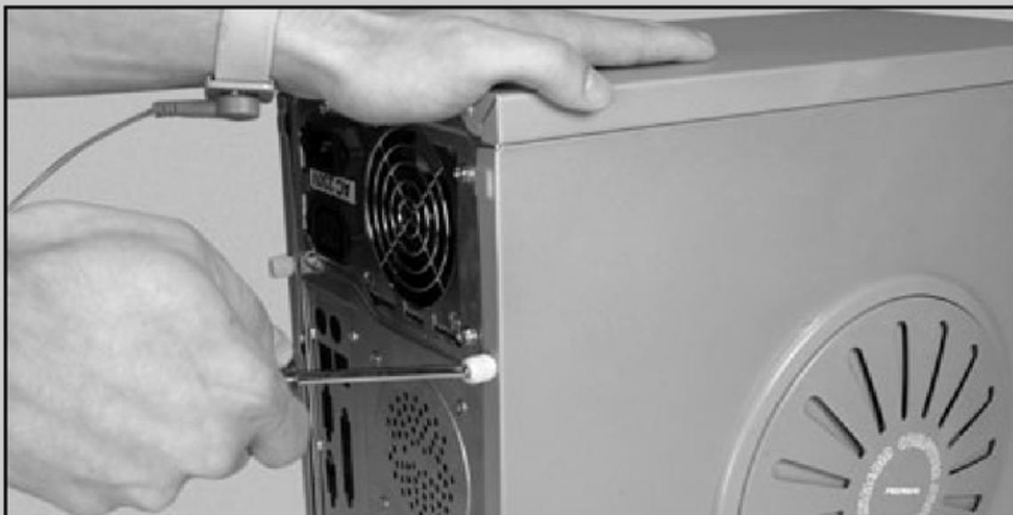
El segundo paso de este procedimiento consiste en retirar la tapa para acceder al interior de la computadora personal y poder instalar la tarjeta.
