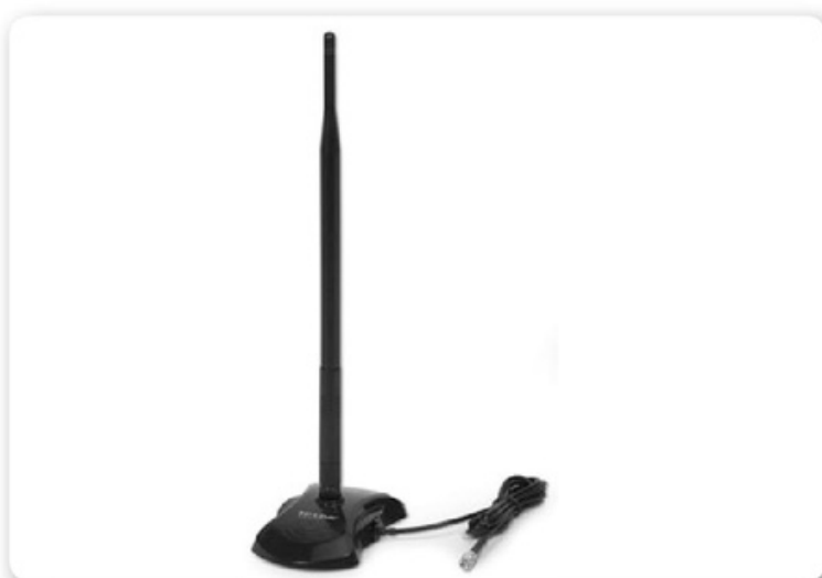
► Figura 1. Las antenas cumplen la función de mejorar el alcance de la red inalámbrica o de la placa de red.
