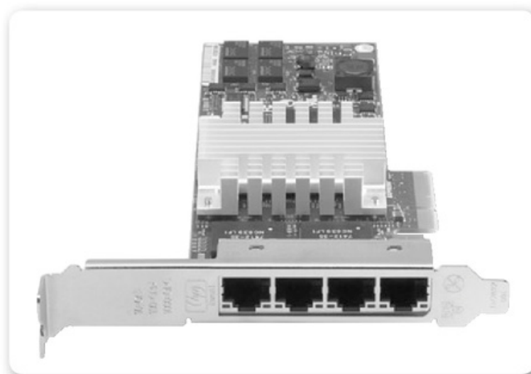
► Figura 5. La tarjeta de red de cuatro puertos es una opción muy eficiente, aunque no necesaria para la implementación de una red doméstica.
