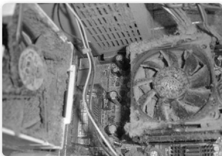
► Figura 8. La acumulación excesiva de polvo dentro del gabinete puede elevar la temperatura y producir cortocircuitos.
