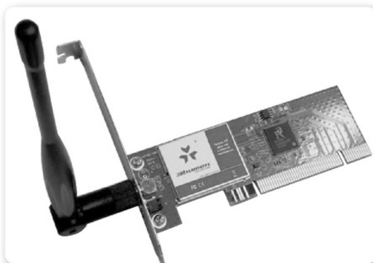
► Figura 2. Por lo general, podemos encontrar la MAC de una placa de red pegada sobre el dispositivo.
