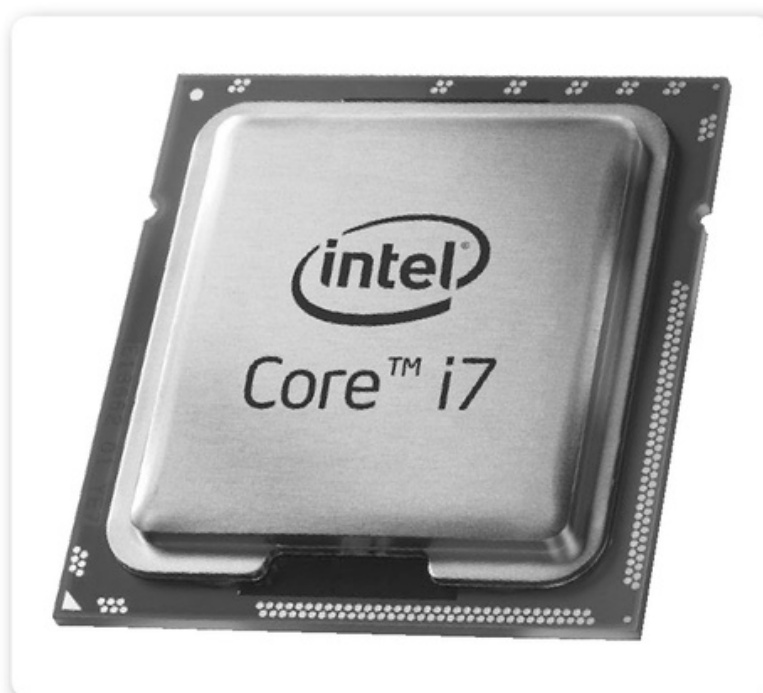
► Figura 7. Debemos tener en cuenta que el procesador es uno de los dispositivos que más se deben proteger de las altas temperaturas.
