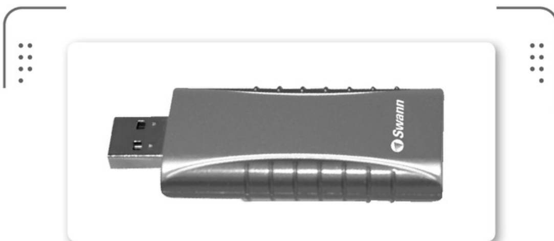
► Figura 20. Los adaptadores infrarrojos pueden encontrarse en tamaños similares a un pen drive.
