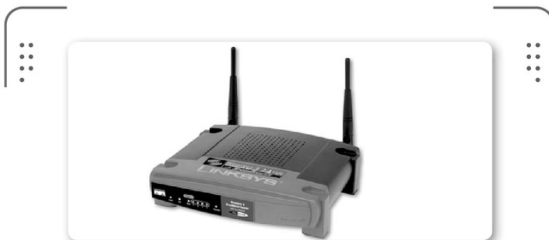
► Figura 15. Los routers trabajan en esta capa de red permitiendo que los paquetes de datos sean direccionados al destino adecuado.
