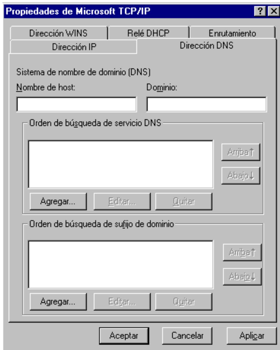
Figura 24. Configuración de *Dirección DNS* cuando se utiliza DHCP
