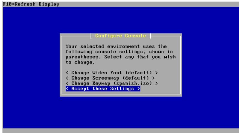
Figura 7. Instalación de pfSense, aceptar configuración de consola
