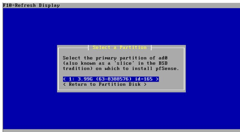
Figura 10. Instalación de pfSense, seleccionar la partición de pfSense
