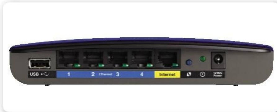
**Figura 11.** Router utilizado en redes de área local cableadas. Encamina información entre redes diferentes.
