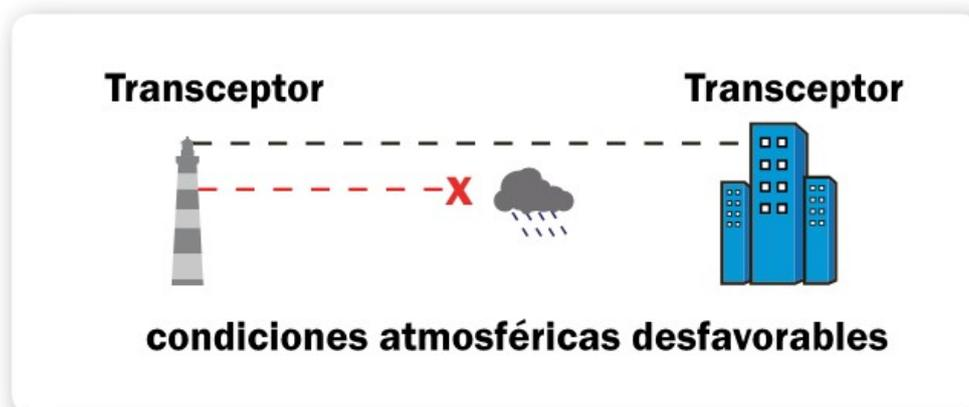
**Figura 9.** Efecto de las condiciones climáticas adversas sobre una comunicación FSO. Podría suprimir totalmente el haz luminoso.
