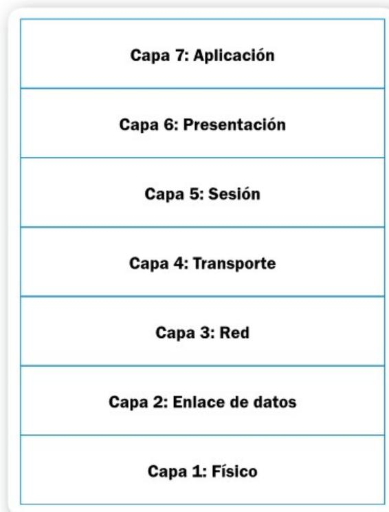
**Figura 2.** En el modelo OSI cada capa cumple una función específica.
