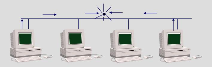
Cuando dos estaciones transmiten a la vez se produce una colisión.
