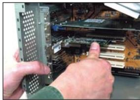
**5** Fija la tarjeta con un tornillo. Cierra la carcasa del PC y vuelve a enchufarlo. Conecta el cable de red a la tarjeta.
