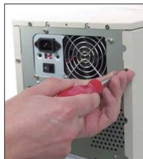
tendrás que aflojar los tornillos de la parte posterior o presionar un lateral.
