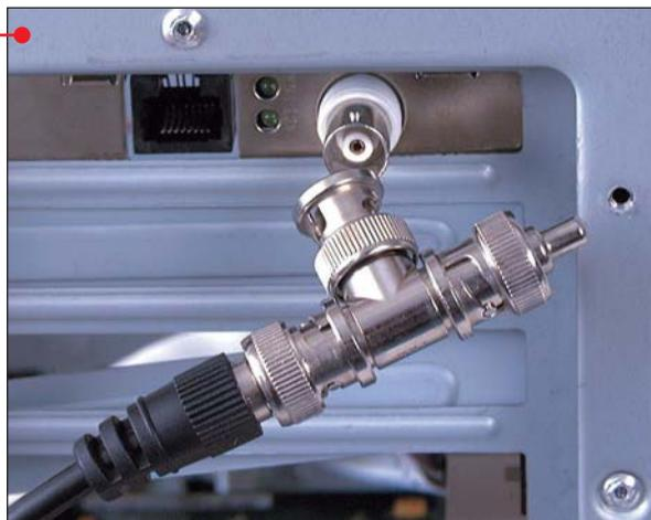
El cable coaxial tiene una resistencia de cierre en cada extremo. No necesita un hub...
