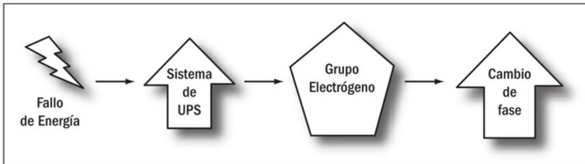
**Figura 3.** Pasos en los que deberíamos pensar cuando se produce un corte de energía: primero nos resguardan los equipos **UPS**; luego, el **grupo electrónico** y, por último, se realiza un **cambio de fase** en la red de energía.
