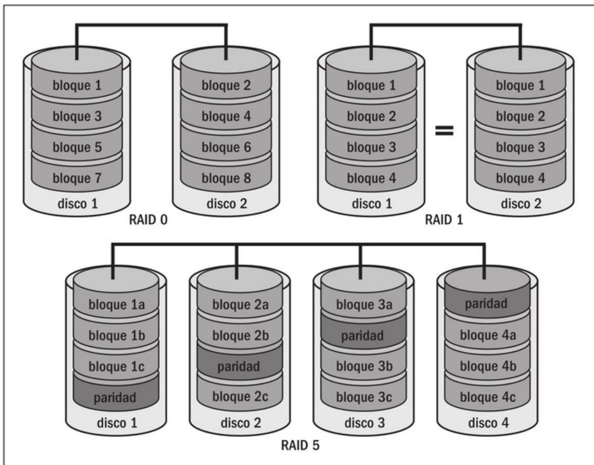
**Figura 2.** En el gráfico podemos ver las diferencias entre los tipos de RAID. El RAID 0 es uno solo dividido, el RAID 1 es un espejo, y el RAID 5 es dividido pero con un control extra para que no se corrompan los datos.
