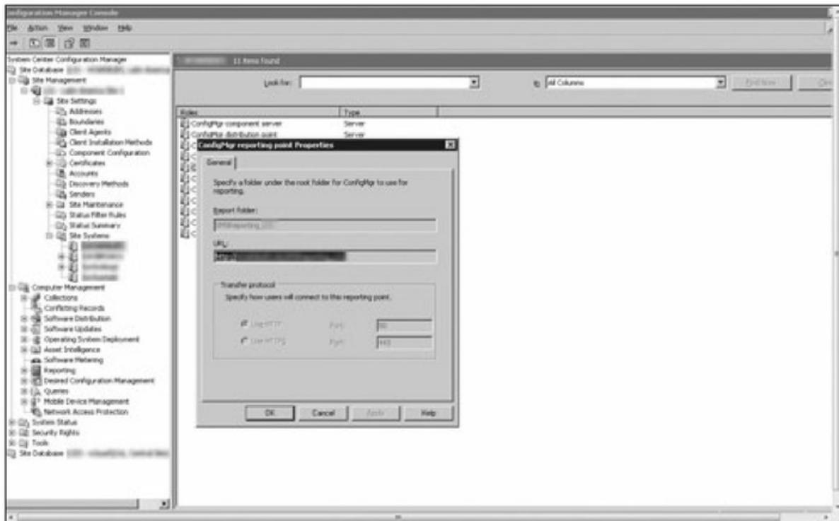
**Figura 6.** En la figura se ven las propiedades del rol Reporting Point instalado por default en el servidor principal. Aquí se define el sitio web en el que se revisarán los reportes.
