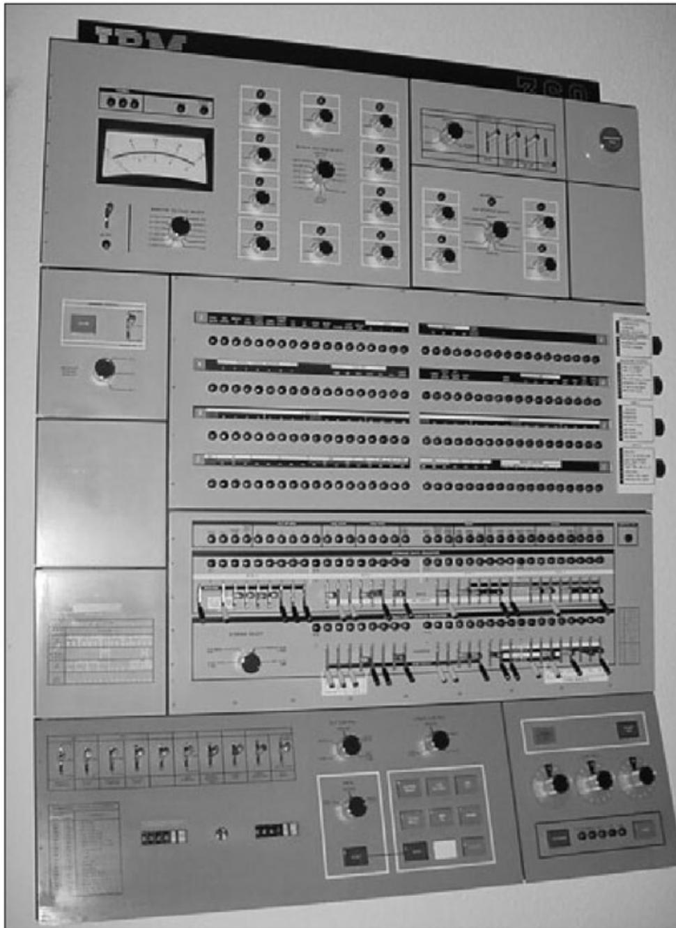
**Figura 3.** Así se veía el panel de control del mainframe S/360. Todos los paneles de los distintos modelos eran parecidos, muy distintos de lo que estamos acostumbrados a ver hoy en día. La virtualización no es algo nuevo.
