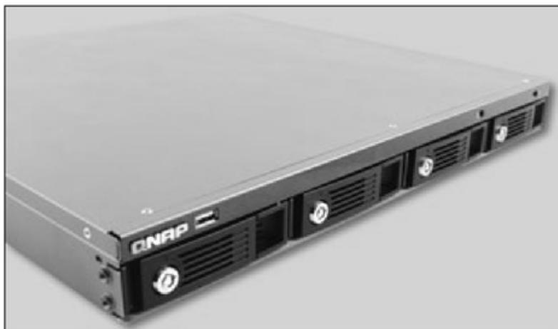
**Figura 7.** Un sniffer QNAP es un ejemplo de este tipo de equipos que se conectan a la red y filtran todos los paquetes que circulan por ella.
