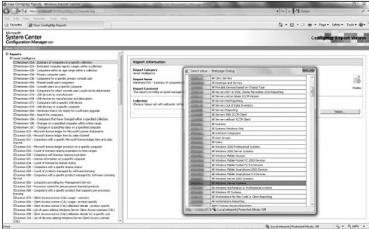
**Figura 8.** Si oprimimos Values..., se abrirá una ventana emergente con un listado de las posibles colecciones que podemos elegir.
