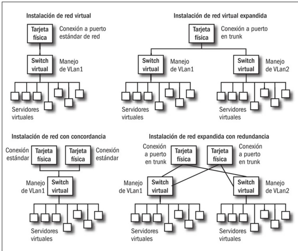
**Figura 8.** Hay por lo menos cuatro formas de conectar las redes virtuales y físicas. Cisco está desarrollando switches físicos que soporten 10 GB para modificar la gran cantidad de cables que deberíamos conectar al ESX/ESXi.
