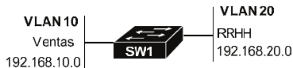
Fig. 2-12.1 Diseño de red segmentada en VLANs.
