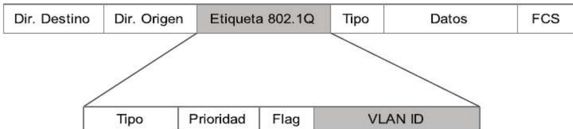
Fig. 2-15 Etiquetado VLAN 802.1Q.
