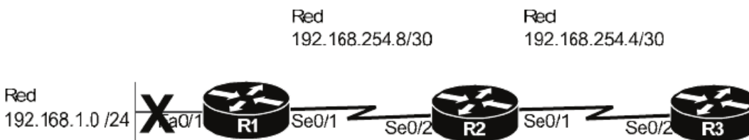
Fig. 6-3.2 Generación de un bucle en capa 3.
