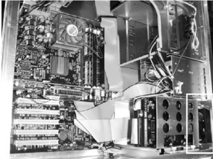
Figure 5-6: Proper fan placement
