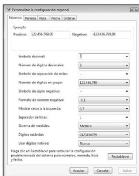
Figura 5. Aquí establecemos el estilo de puntuación que se aplicará en las expresiones de Excel, si es que no indicamos lo contrario en la configuración de Excel.
