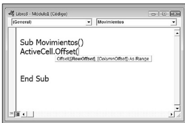
Figura 10. Con la propiedad Offset indicamos la posición de una celda respecto de otra.
