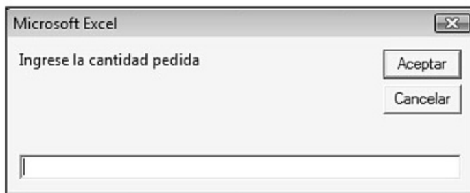
Figura 23. La instrucción InputBox muestra un mensaje en la pantalla con una caja para escribir una respuesta.
