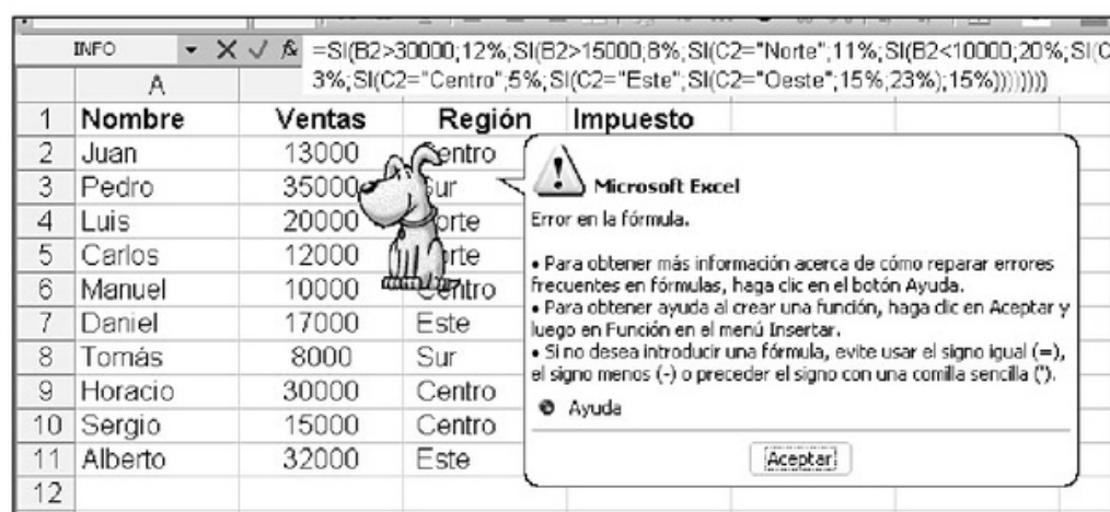
Figura 7. La fórmula de la celda D2 tiene muchas funciones SI , una dentro de la otra. Más de las que admite Excel 2003.
