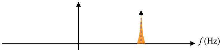
Figura 4-19. Densidad espectral de potencia de la salida de un oscilador.
