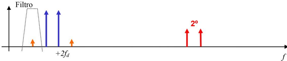
Figura 3-22. Medida de la potencia de los tonos de intermodulación de tercer orden en la prueba de dos tonos.
