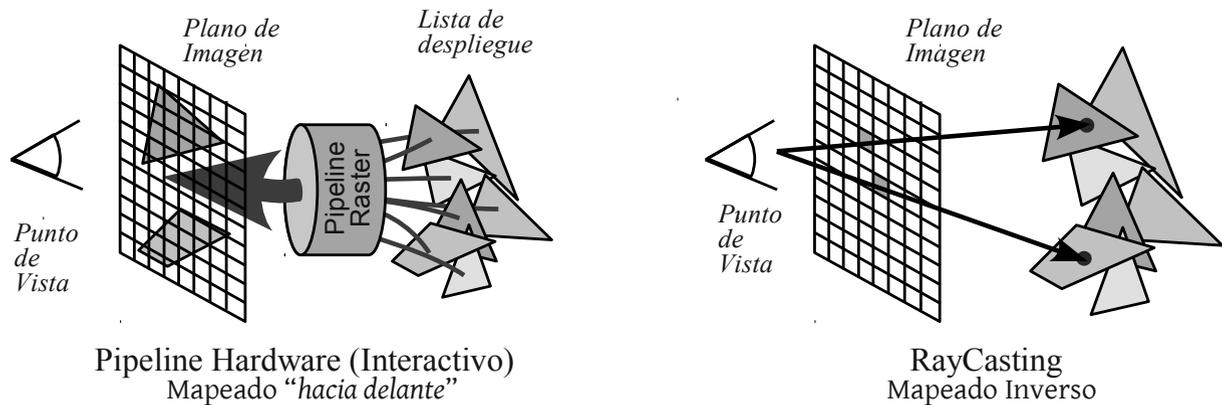
**Figura 1.2:** Diferencias entre las técnicas de despliegue interactivas (métodos basados en *ScanLine*) y realistas (métodos basados en *RayCasting*). En el Pipeline Hardware, la selección del píxel más cercano relativo a cada triángulo se realiza directamente en Hardware, empleando información de los *fragmentos* (ver Sección 1.2).
