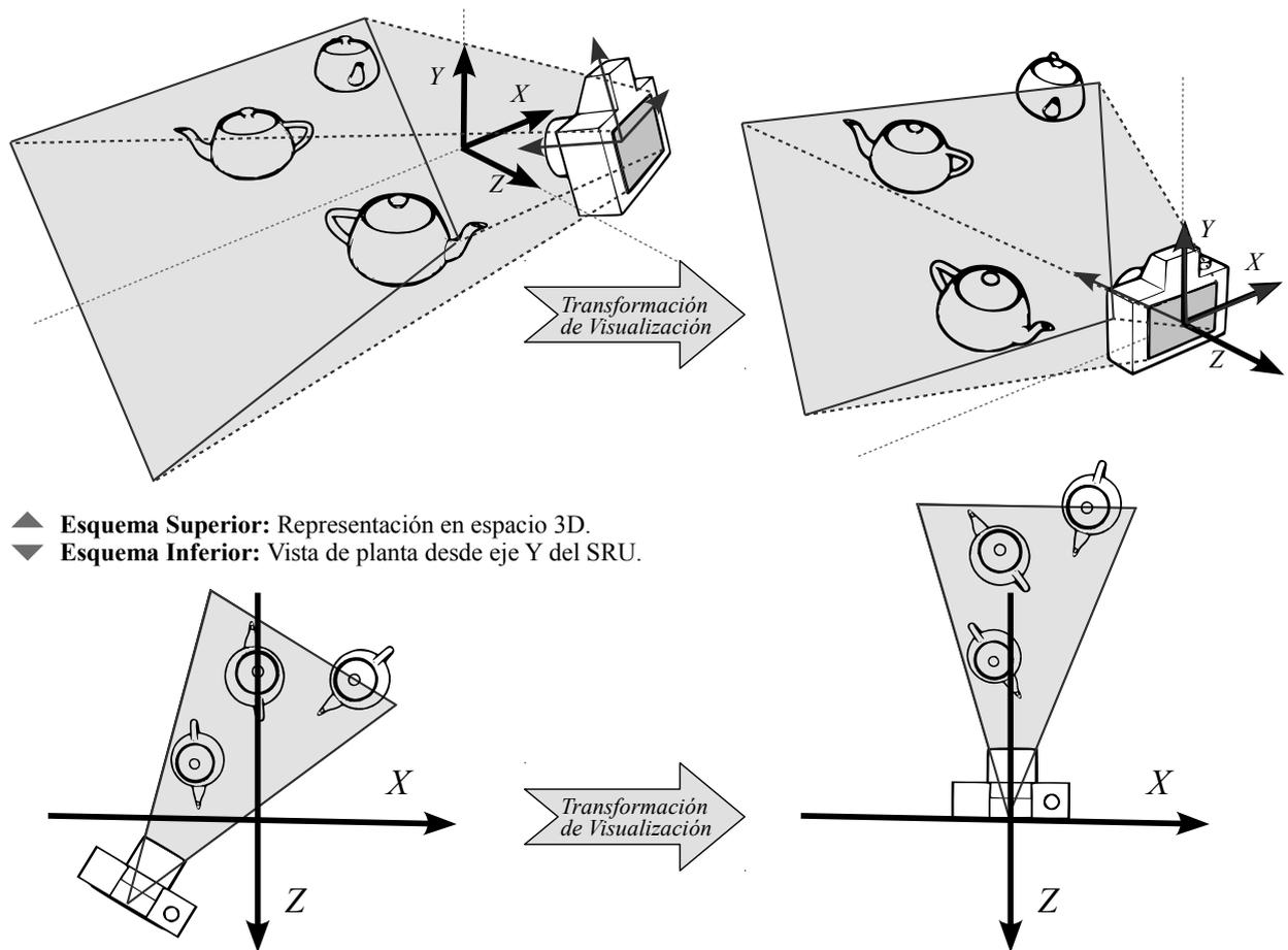
**Figura 1.5:** El usuario especifica la posición de la cámara (izquierda) que se transforma, junto con los objetos de la escena, para posicionarlos a partir del origen del SRU y mirando en la dirección negativa del eje Z. El área sombreada de la cámara se corresponde con el volumen de visualización de la misma (sólo los objetos que estén contenidos en esa pirámide serán finalmente representados).
