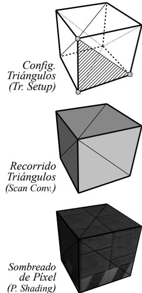
**Figura 1.7:** Representación del resultado de las principales etapas del Pipeline de Rasterización.
