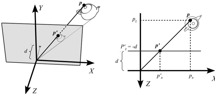
**Figura 1.9:** Modelo de proyección en perspectiva simple. El plano de proyección infinito está definido en  $z = -d$ , de forma que el punto  $p$  se proyecta sobre  $p'$ .
