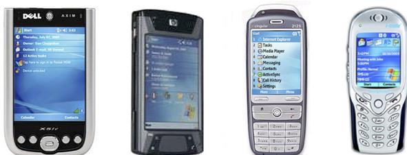
Para sincronizar datos y comunicarse, estos dispositivos incorporan mecanismos como USB, WiFi, Bluetooth o IrDa (infrarrojos). La sincronización de los datos con un PC se lleva a cabo con el programa ActiveSync de Microsoft o mediante el centro de sincronización de dispositivos en Windows Vista.
