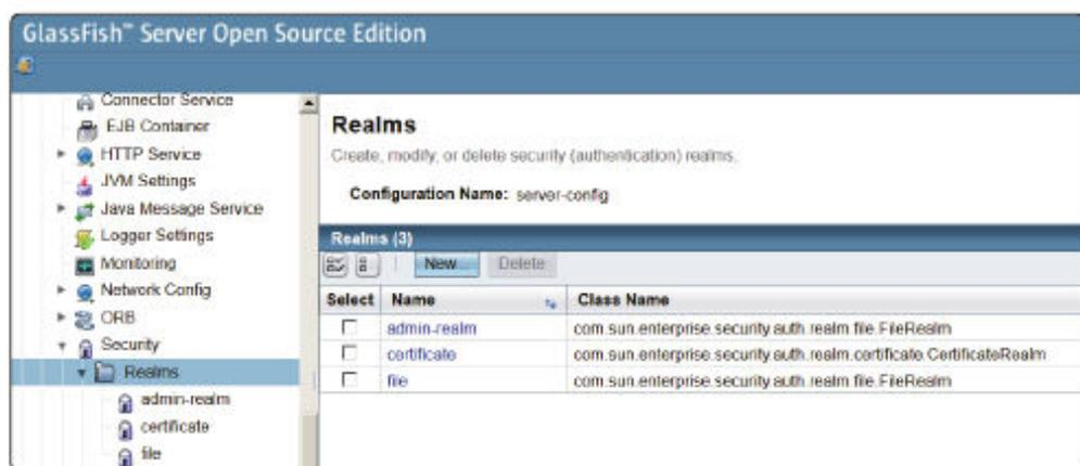
Figura 4.34. Realms configurados por defecto en GlassFish
