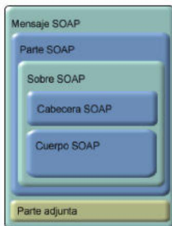
Figura 3.2. Elementos de un mensaje SOAP con adjuntos
