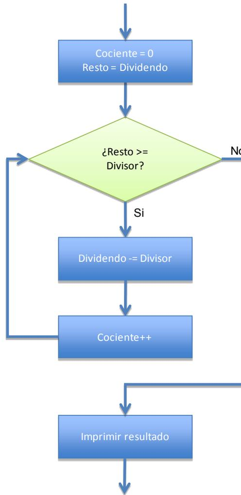
Figura 42. Diagrama de flujo de una división básica.
