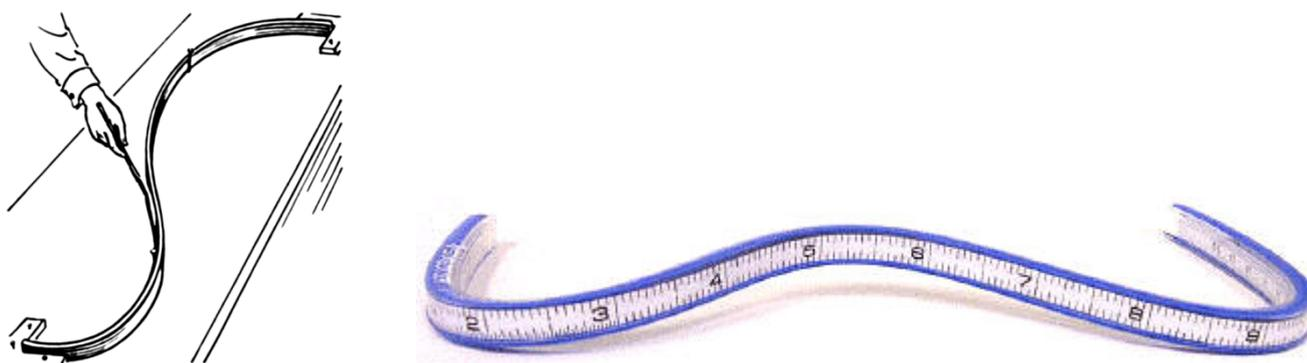
Figura 62. Regla flexible para el trazado de curvas “spline”
