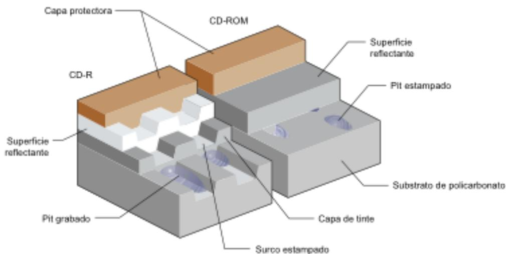
Figura 10. Capas de un CD-ROM y un CD-R
