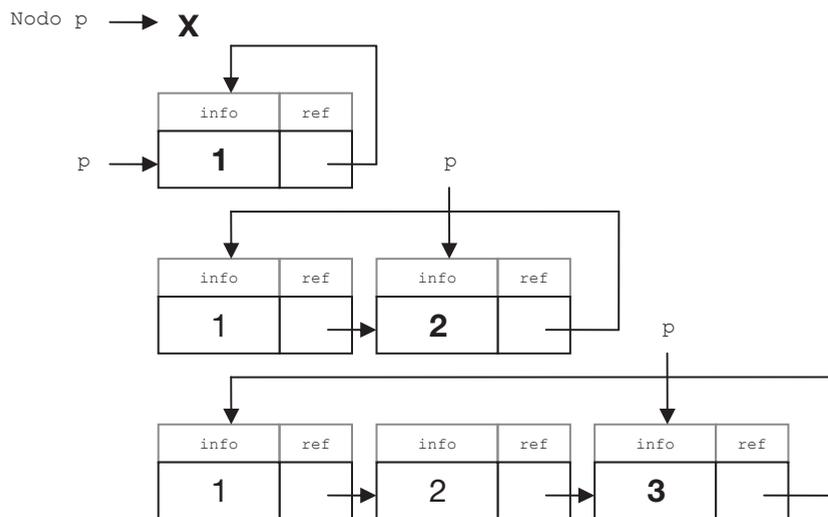
Fig. 9.2 Cola implementada sobre una lista circular.
