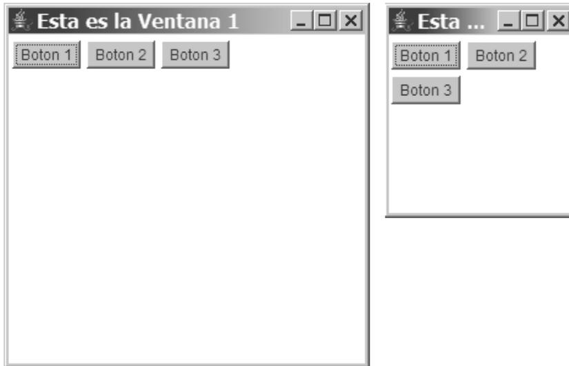
Fig. 5.4 y Fig. 5.5 FlowLayout alineado a izquierda.
