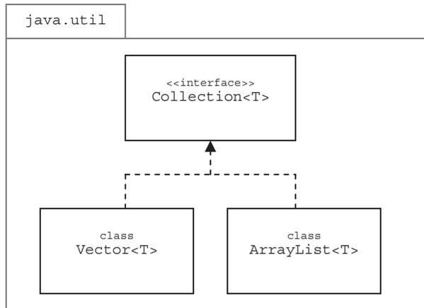
Fig. 2.6 Representación de las clases `Vector` y `ArrayList`.
