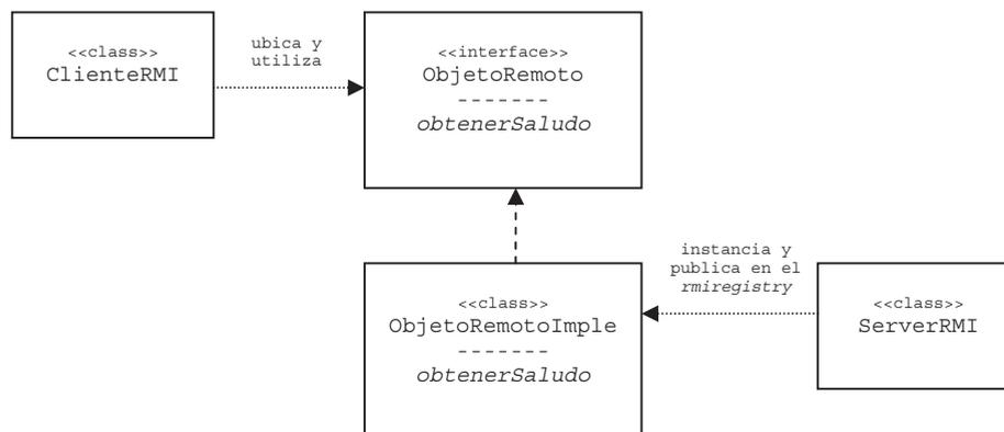
Fig. 7.1 Diagrama de clases de una aplicación RMI.
