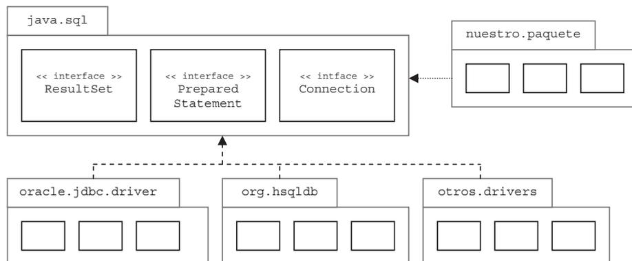
Fig. 3.2 Diagrama UML de dependencia de paquetes.
