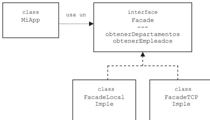
Fig. 8.6 La *interface* `Facade` y sus implementaciones.
