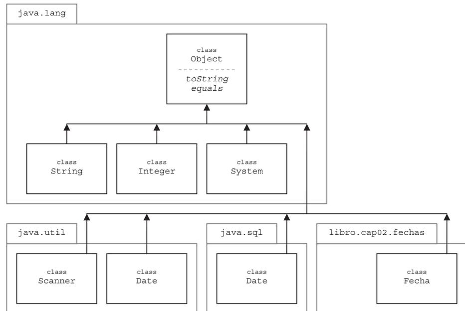
Fig. 2.1 Diagrama de clases y paquetes de UML.
