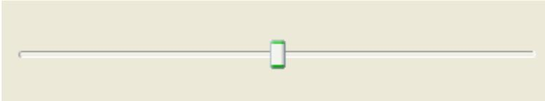
Estos elementos tienen un pequeño recuadro que se puede arrastrar a derecha o izquierda. Según la posición del recuadro, el JSlider tendrá un valor concreto.
