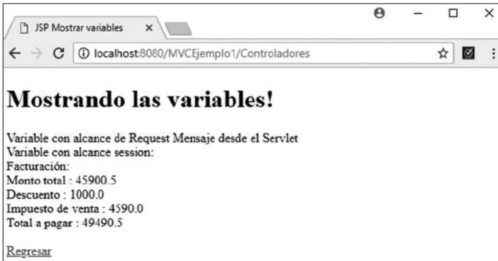
Figura 11.5 Ejecución de `mostrarVariables.jsp` invocado desde ServletControlador
