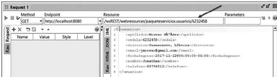
Figura 10.68 Prueba de la operación GET con un solo registro
