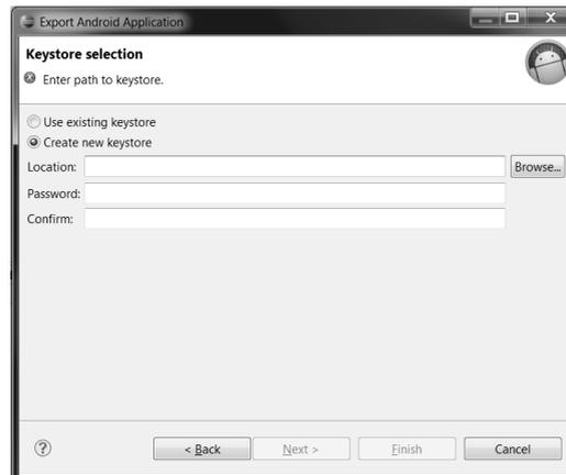
**Fig. 7.7.** La firma puede crearse en ese momento o puede utilizarse una previamente creada para añadirla a la aplicación que se está empaquetando.
