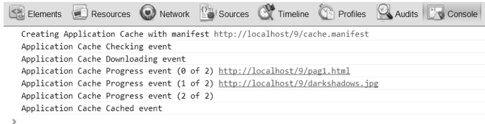
**Fig. 3.12. En Google Chrome, accediendo a la solapa *Console* de las *Herramientas para desarrolladores*, es posible observar el progreso del proceso de cacheo para seguir los estados y saber si el procedimiento se ha completado de manera exitosa o con algún error.**
