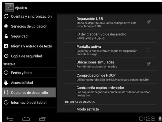
**Fig. 6.18.** Los dispositivos Android 4.x, dentro de la pantalla **Ajustes** cuentan con **Opciones de desarrollo**. Desde allí, se puede habilitar **Depuración USB** para configurar el modo de depuración de un dispositivo que está conectado mediante el puerto USB a la computadora. En algunas versiones de Android 4.2.x es necesario buscar esta opción, ya que se no se encuentra visible por defecto (<http://developer.android.com/tools/device.html#setting-up>).
