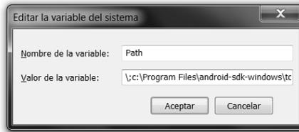
**Fig. 6.11.** En la ventana **Editar la variable del sistema**, al agregar una nueva ruta en **Valor de la variable**, al final de la línea es necesario colocar un punto y coma (;) y luego escribir los **paths** que se deben agregar.
