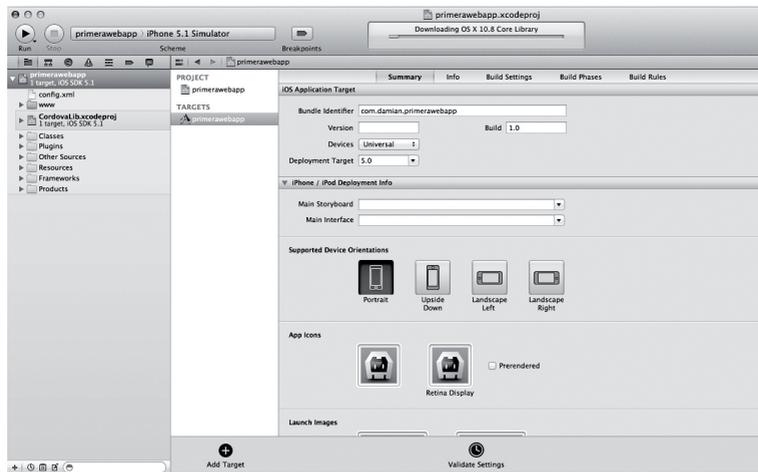
**Fig. 6.20.** Pantalla de Xcode donde se pueden visualizar las carpetas del proyecto, el **target** definido para la aplicación y otras opciones acerca de la orientación del dispositivo, íconos e imágenes.
