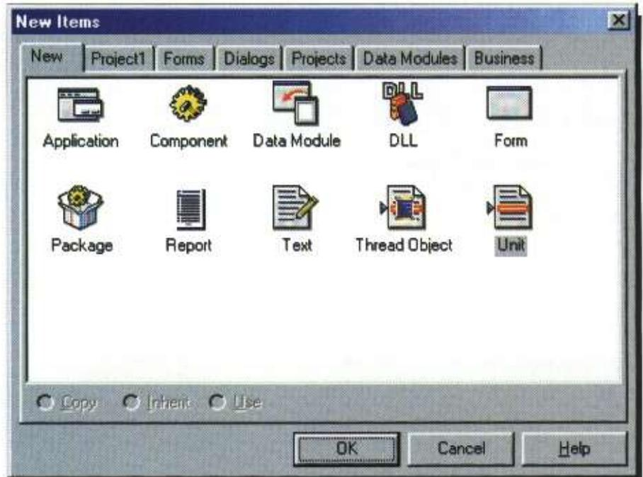
**FIG. 6** La secuencia de menú **File | New** permite crear módulos no asociados a fichas para funciones y procedimientos.
