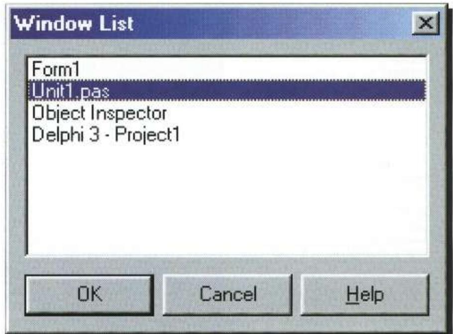
**FIG. 10** La Window List permite elegir directamente el elemento que se desea llevar a primer plano del área de trabajo.
