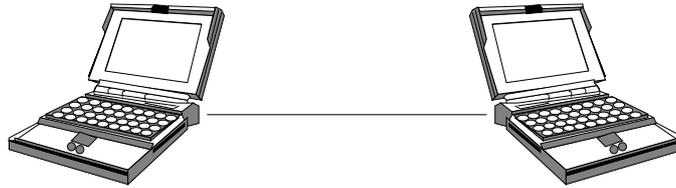
Una comunicación punto a punto half-duplex requiere de un cable que una ambos nodos; una comunicación punto a punto full-duplex requiere de dos cables que unan ambos nodos, o alguna forma de que dos señales puedan viajar al mismo tiempo en sentidos diferentes por el mismo medio de comunicación, como por ejemplo modular cada una de ellas con diferente frecuencia portadora.
