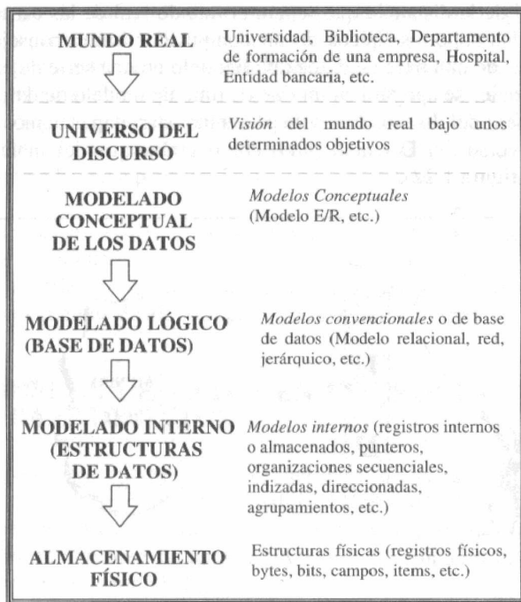
Figura 1.23. Etapas en el diseño de una base de datos y tipos de modelos en los que se apoyan
