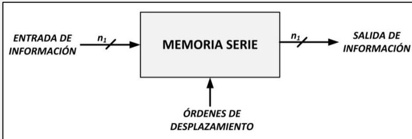
Fig. 6.20. Esquema de una memoria serie posición a posición.
