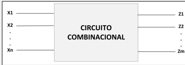
Fig. 4.4. Diagrama en bloque de un sistema o circuito combinacional.
