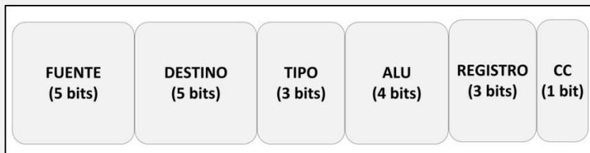
Fig. 8.16. Formato de una microinstrucción del 8088.
