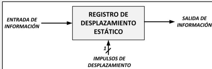
Fig. 6.22. Esquema de un registro de desplazamiento estático.
