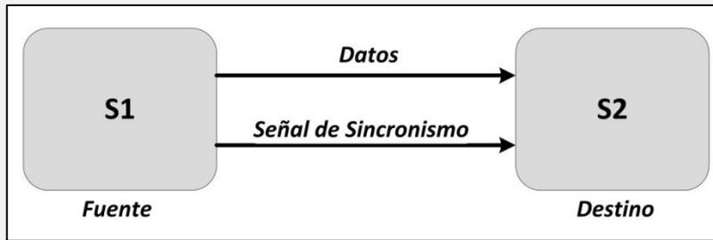
Fig. 10.10. Transmisión Paralela estroboscópica.
