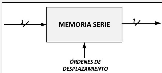
Fig. 6.18. Esquema de una memoria serie bit a bit.
