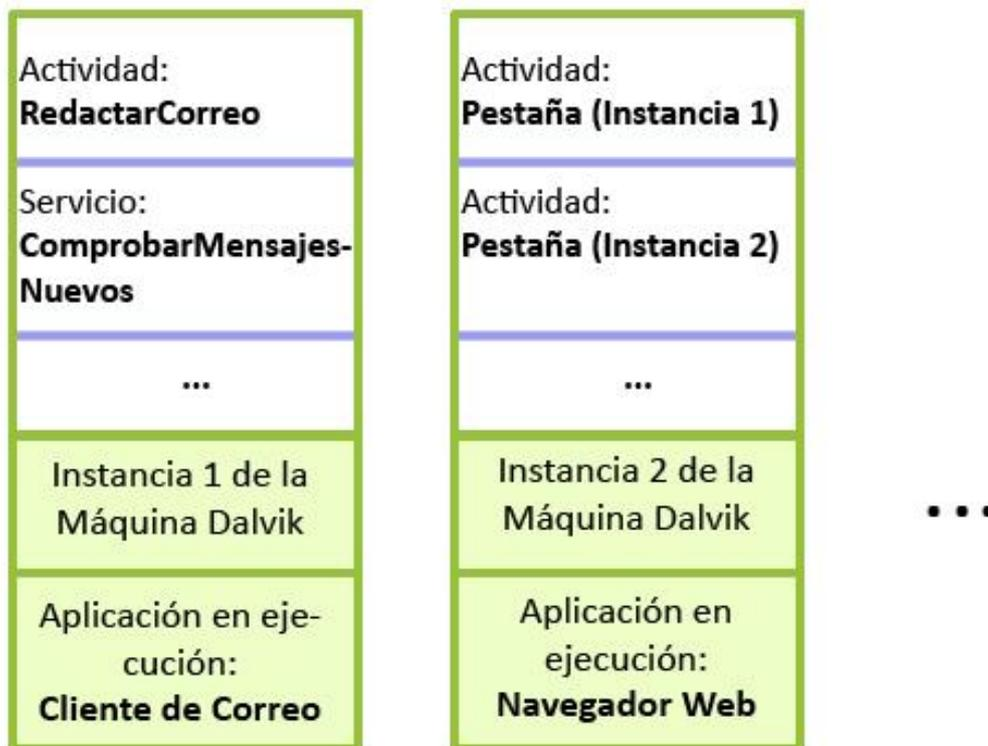
Figura 2.5: Ejemplo de las instancias de la máquina Dalvik activas durante la ejecución del sistema Android.
