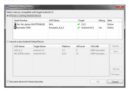
En este caso hay dos dispositivos ya disponibles, un dispositivo físico conectado al ordenador y un emulador. El dispositivo físico es un móvil HTC Desire con un sistema operativo Android 2.2.2 (Froyo) instalado mientras que el emulador consta de una versión Android 4.0.3 (Ice Cream Sandwich).
