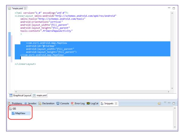
Guarde los cambios y localice ahora el fichero con la *Activity* creada automáticamente. Verá que dentro de la clase hay un objeto "MapView" que en el método "onCreate" se instancia. No es necesario instanciarlo de este modo ya que lo ha definido en el *layout*, por lo que puede sustituirla por la siguiente línea de código:
