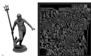
Figura 9.10: Despliegue del modelo de Neptuno empleando Lightmap UVPack . Cada cara poligonal tiene asociado un espacio propio en la textura.
