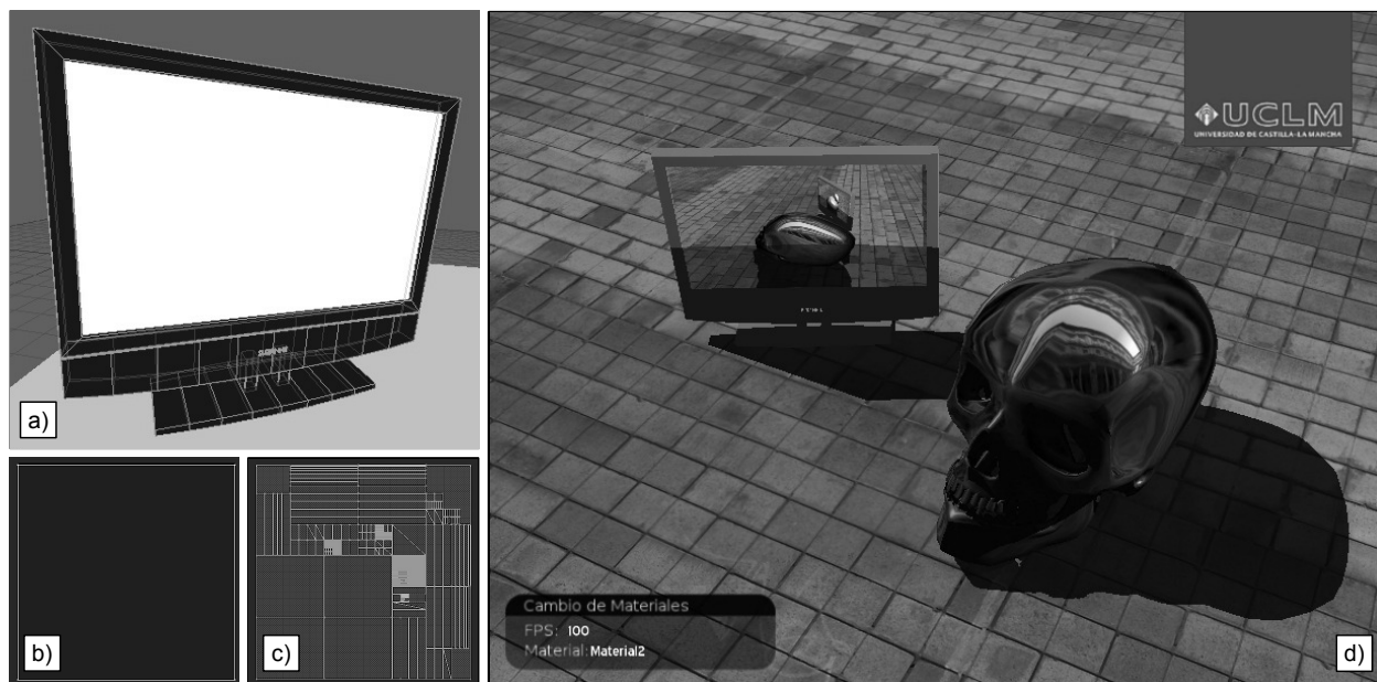
Figura 7.28: Construcción del ejemplo de Render a Textura (RTT) . a) Modelo empleado para desplegar la textura de RTT. El modelo se ha definido con tres materiales; uno para la carcasa, otro para las letras del logotipo (ambos desplegados en c) , y uno para la pantalla llamado “ pantallaTV ”, desplegado en b) . En d) se muestra el resultado de la ejecución del programa de ejemplo.
