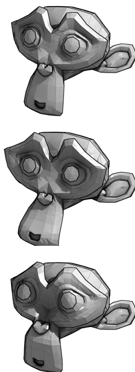
Figura 1.12: Resultado de aplicar un Vertex Shader para deformar un modelo.
