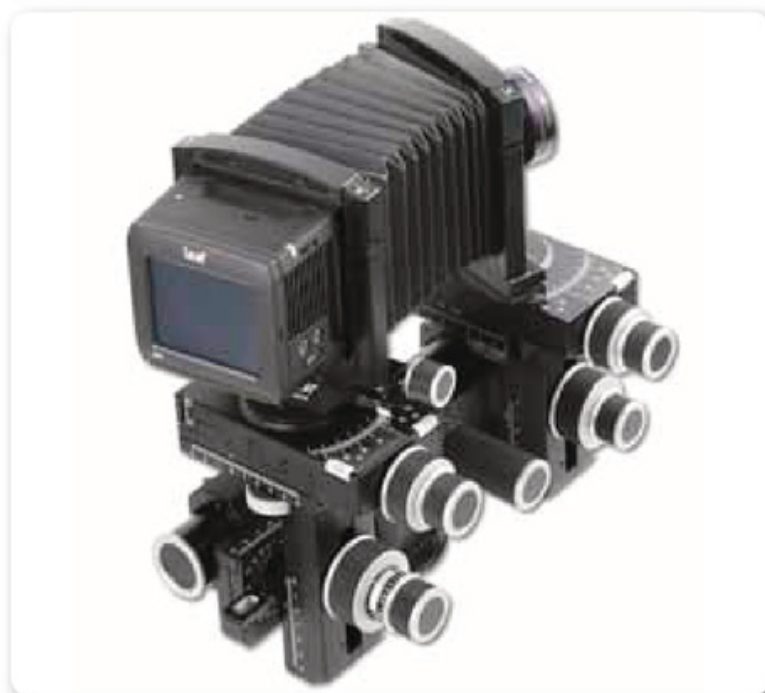
Figura 2. Afortunadamente las cámaras de formato grande se han digitalizado al adaptar respaldos de captura de gran resolución.
