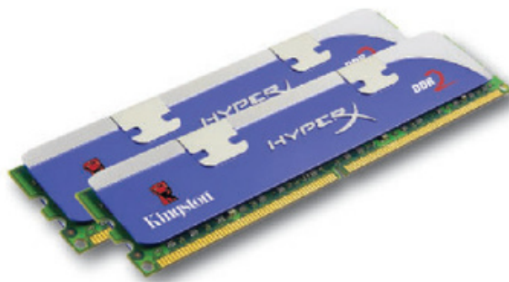
Figura 5. Para aprovechar mejor su rendimiento, las memorias siempre deben instalarse en pares. De esta manera, si vamos a instalar 4 GB , hagámoslo mediante dos módulos de 2 GB .
