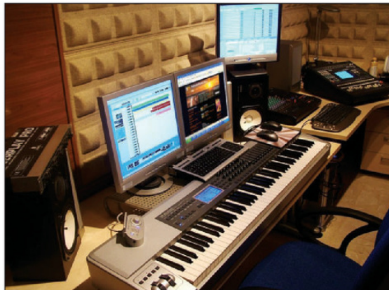
Figura 17. Las habitaciones recubiertas de alfombras y paneles absorbentes son excelentes para la disminución del eco, que resulta muy molesto cuando alguien habla al micrófono.
