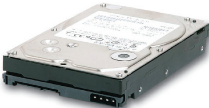
Figura 6. Si instalamos dos discos duros no sólo nos aseguramos un mayor rendimiento, sino la protección del material de video en el caso de que el disco principal (que contiene a Windows) llegara a fallar.
