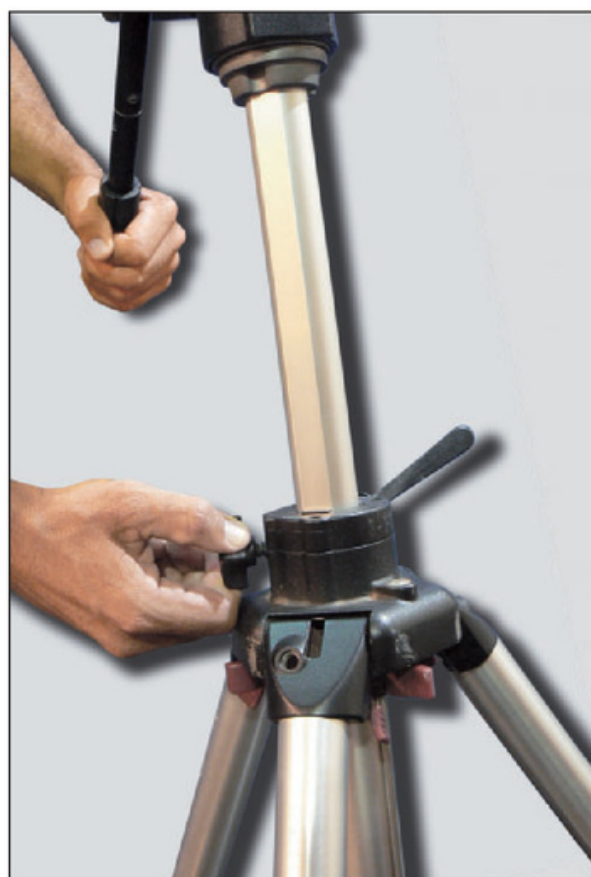
Figura 16. Un brazo extensible nos permite elevar la cámara por encima de la altura máxima que nos brinden las patas.
