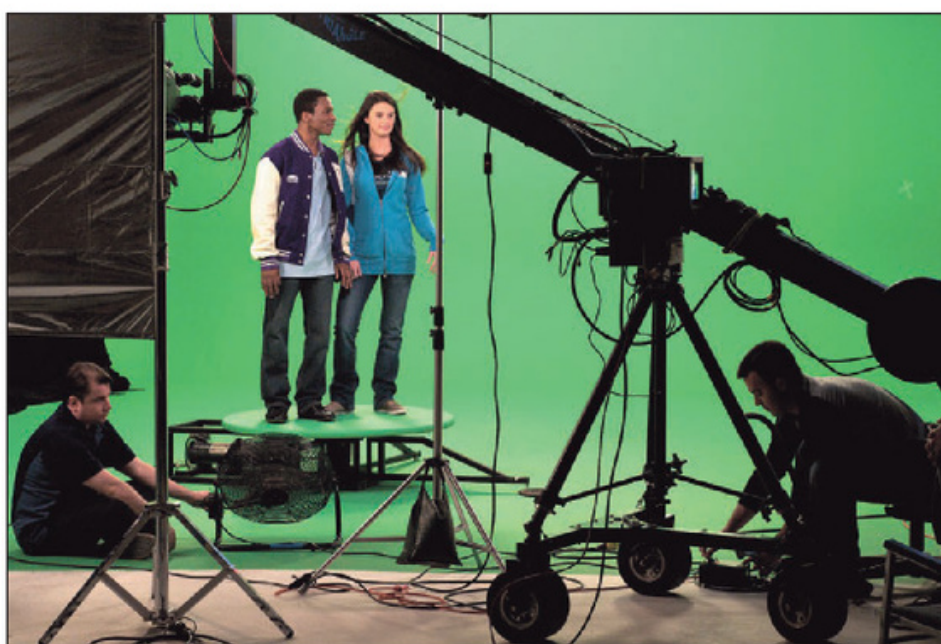
Figura 28. Esta instalación nos permite hacer Chroma Key con planos generales, cubriendo al protagonista desde los pies hasta la cabeza.
