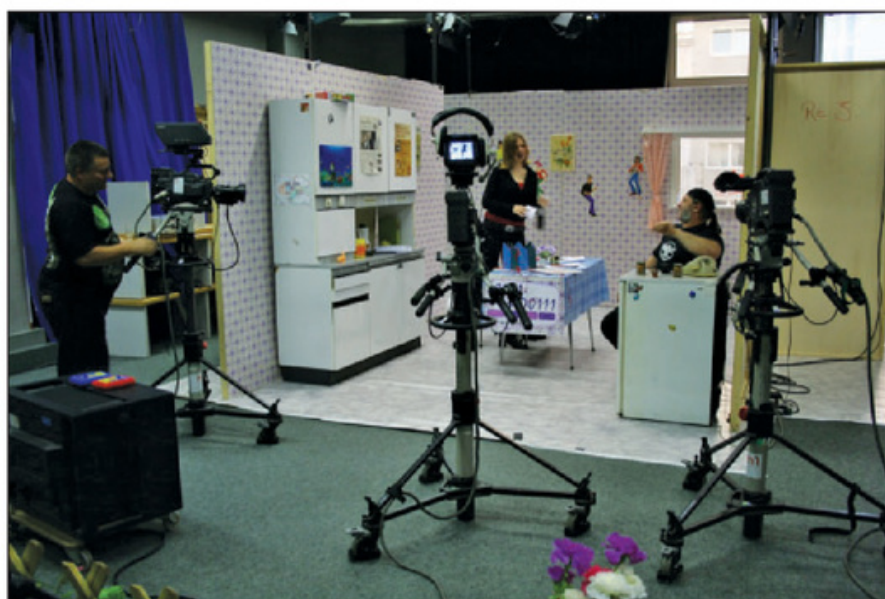
Figura 18. La alternativa más económica para un Dolly es anexoarlo como accesorio al trípode, aunque para su uso debemos movernos sobre una superficie plana.
