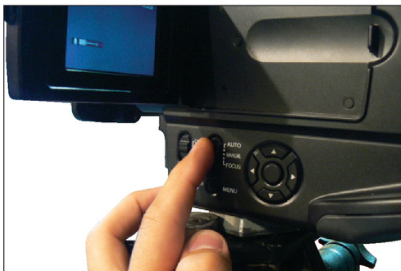
Figura 4. Cambiar entre el sistema de foco manual y el automático no es más complicado que mover una llave selectora.
