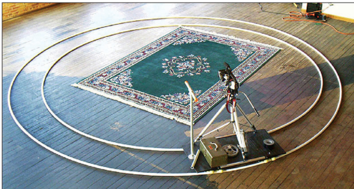
Figura 19. Si vamos a trabajar sobre una superficie irregular, debemos montar el trípode sobre un Dolly basado en rieles, con el recorrido previamente planificado.
