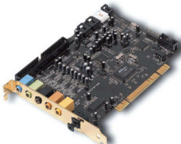
Figura 13. El ejemplo más conocido de un conversor analógico-digital es la placa de sonido de la PC, que a través del conector azul nos permite digitalizar cualquier audio que insertemos.
