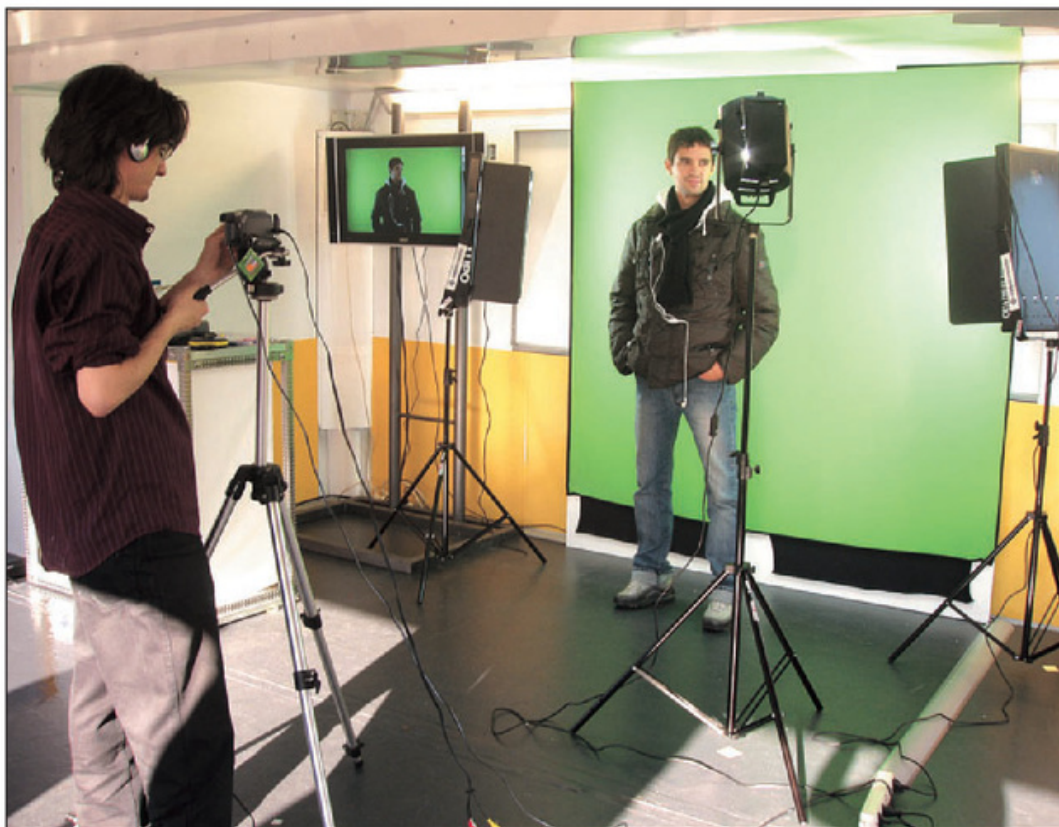
Figura 29. Como vemos en la imagen, la iluminación no sólo se destina al protagonista, sino también al fondo para que el color sea lo más homogéneo posible.
