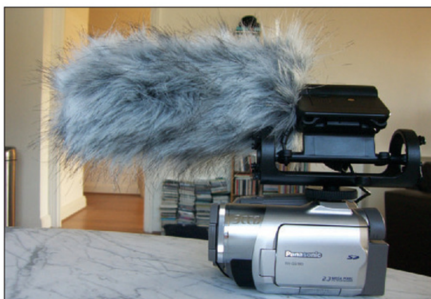
Figura 21. Envolviendo al micrófono con esta felpa, nos aseguramos de filtrar cualquier sonido proveniente del viento o del ambiente.
