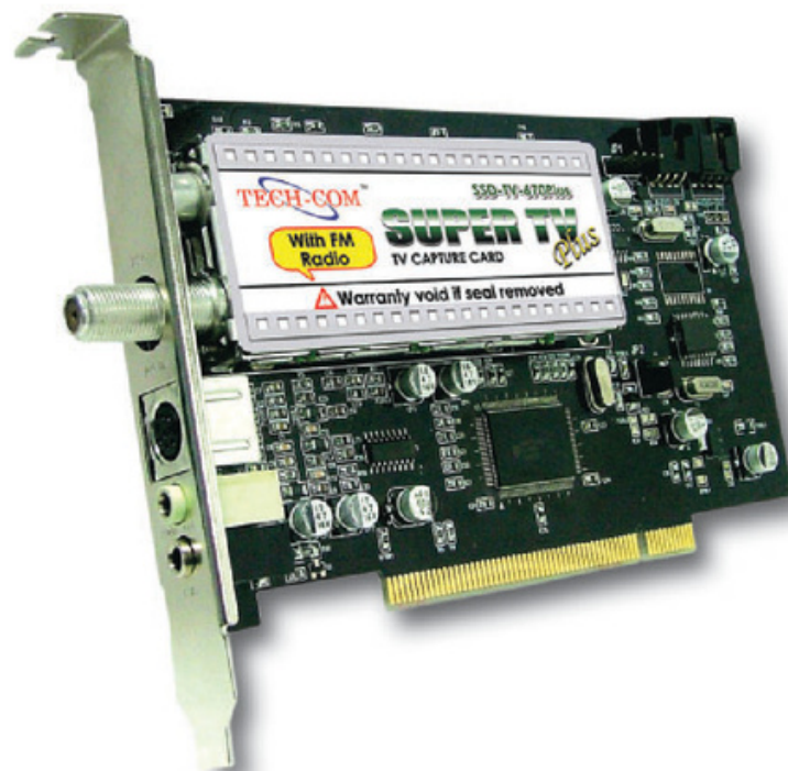
Figura 20. La sintonizadora (que también se consigue en formato PCI o USB) es una buena alternativa para capturar video desde la señal de TV, pero no tan buena para hacerlo desde una videocámara.
