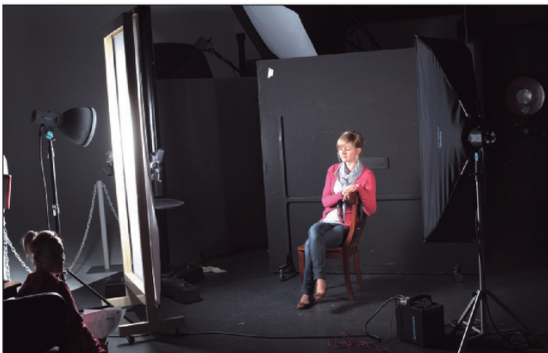
Figura 12. Utilizando un listón de tela o papel vegetal como éste, podemos suavizar la luz para que los contrastes en la imagen no sean tan marcados.
