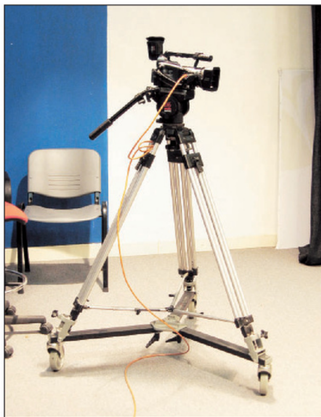
Figura 8. Con un piso alfombrado y un Dolly como éste nos resultará muy simple efectuar movimientos de travelling.
