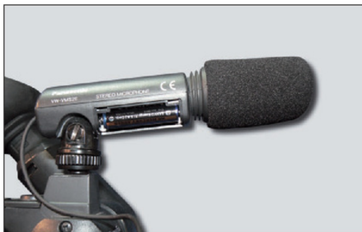
Figura 23. Los micrófonos activos trabajan a partir de una fuente que les provee energía (como una pila) de manera que se amplifique cada detalle del audio que captan.
