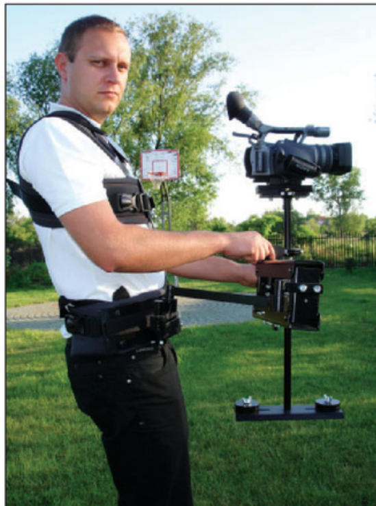
Figura 12. Un Steady no es algo difícil de conseguir y le dará suavidad a nuestras tomas en movimiento, aún en los terrenos más irregulares.
