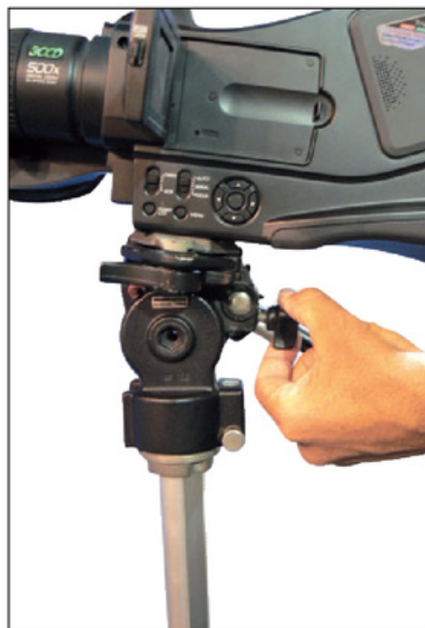
Figura 7. Lo que ajusta la mano del camarógrafo es una mariposa, un tornillo con cabeza plástica que permite ser enroscado para presionar al eje del trípode y evitar que la cámara se siga moviendo.
