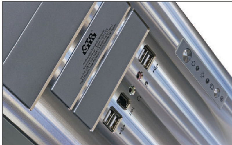
Figura 2. El panel de conexiones frontal que pueda ofrecer nuestro gabinete es fundamental, dado que nos brindará una mayor comodidad para conectar equipos, como la cámara de video.
