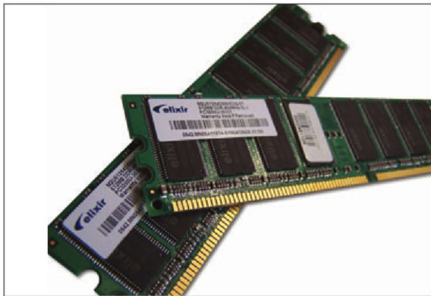
Figura 7. Podemos combinar la cantidad de memoria distribuida entre las dos placas, pero conviene que ambas sean compatibles.
