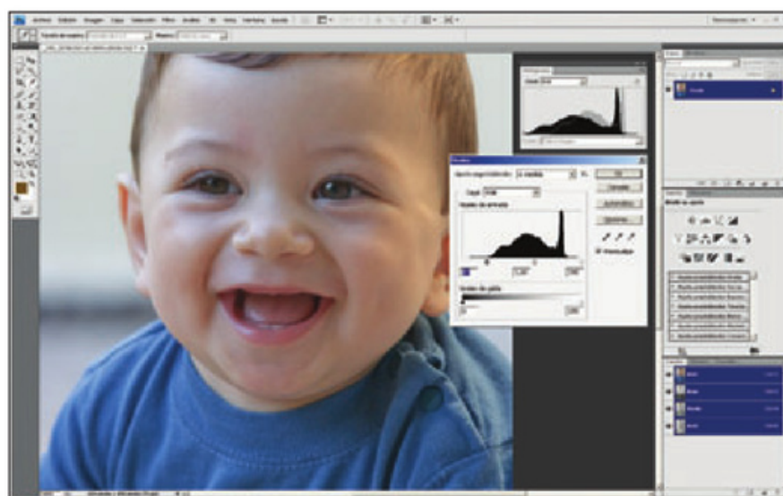
Figura 20. Al modificar los niveles de entrada y al acercar el regulador de control al borde izquierdo del histograma, iniciaremos la corrección de las sombras.
