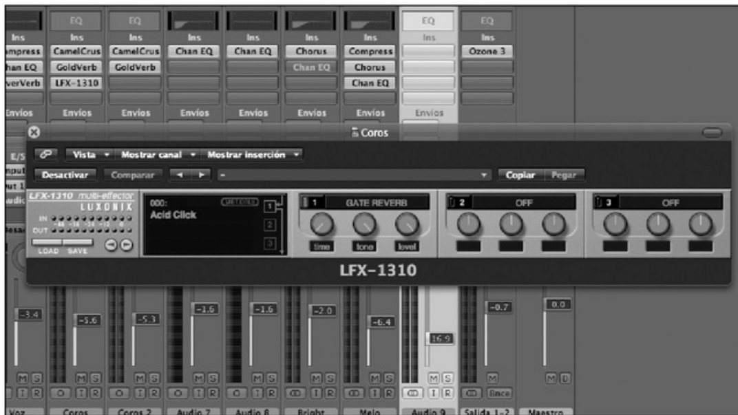
Figura 14. LFX-1310 es un excelente procesador de efectos por etapas que incluye todos los efectos básicos que se usan en la mezcla.
