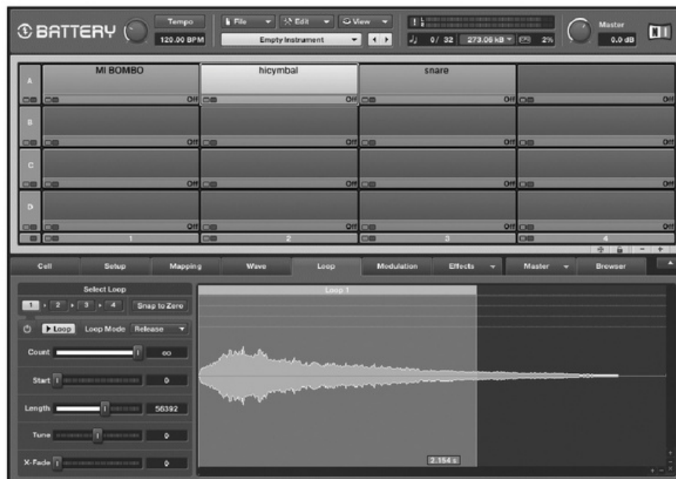
Figura 13. Battery puede reproducir las muestras de audio en bucle. Desde la solapa Loop , podemos crear bucles sobre la base de porciones de un archivo de audio.
