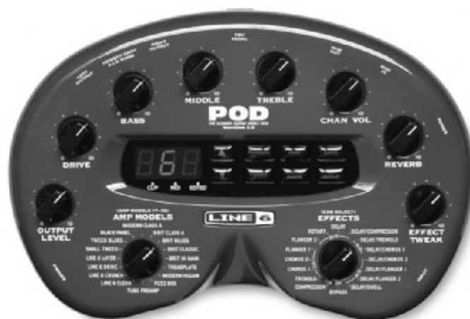
Figura 10. Line 6 Pod es uno de los procesadores más populares de efectos para guitarras. Incluye modelación de amplificadores, que permite grabar una guitarra eléctrica de manera directa, sin utilizar un equipo amplificador.
