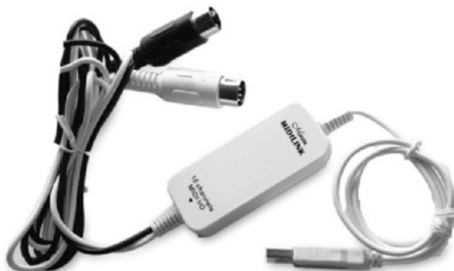
Figura 5. Las interfaces MIDI más populares en la actualidad son las que poseen un conector USB .
