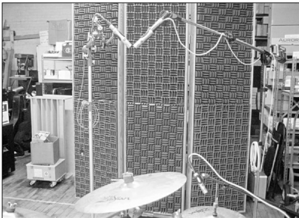
Figura 24. El par coincidente nos permite, por ejemplo, hacer tomas monocompatibles de baterías.
