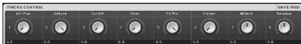
Figura 13. La sección MACRO CONTROL nos ofrece ocho controladores giratorios para modificar el sonido en tiempo real.
