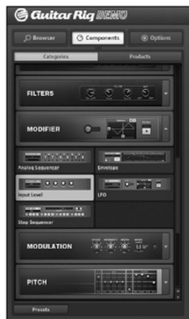
Figura 22. Si el nivel de entrada de la señal es muy bajo, podemos usar INPUT LEVEL para aumentarlo.
