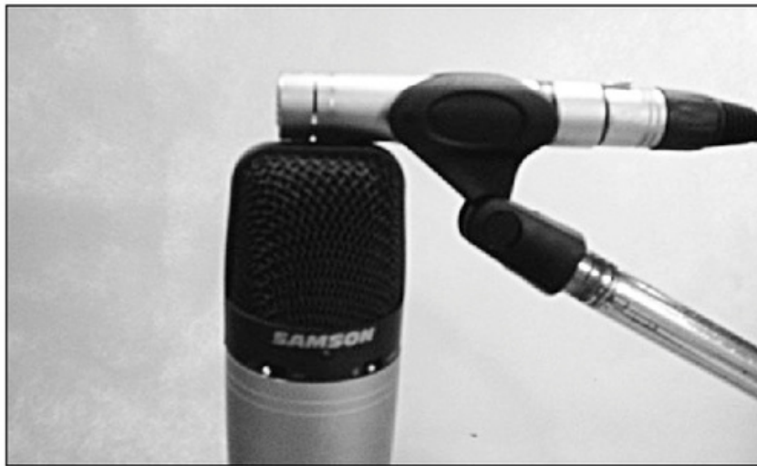
Figura 26. En la configuración Mid-Side se ubica un micrófono cardioide arriba y uno bidireccional abajo.
