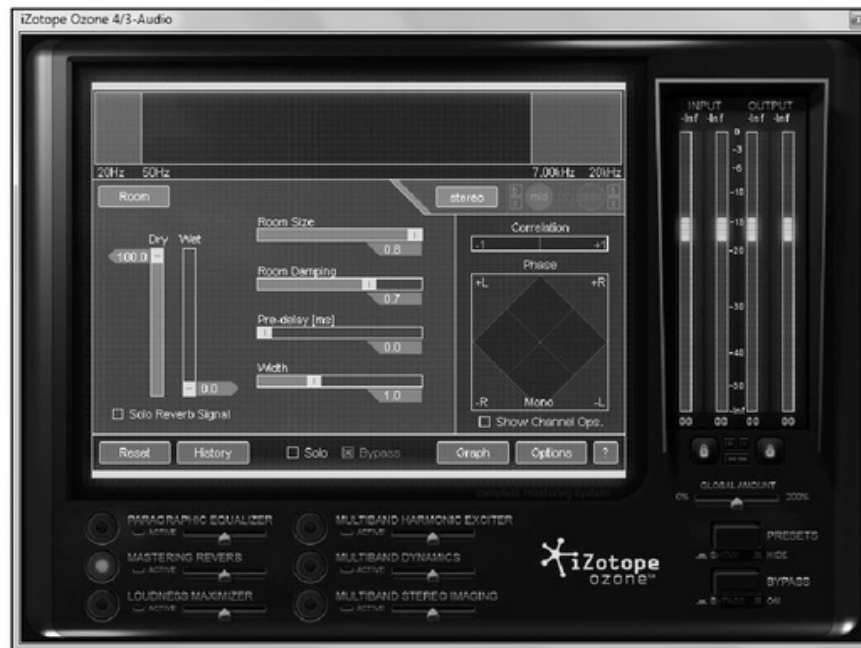
Figura 24. Debemos utilizar la reverb de ozone con fines técnicos (como ensamblar mejor todos los sonidos dentro de un mismo ambiente) y no con fines creativos; puesto que esto último es parte del trabajo del proceso de mezcla.
