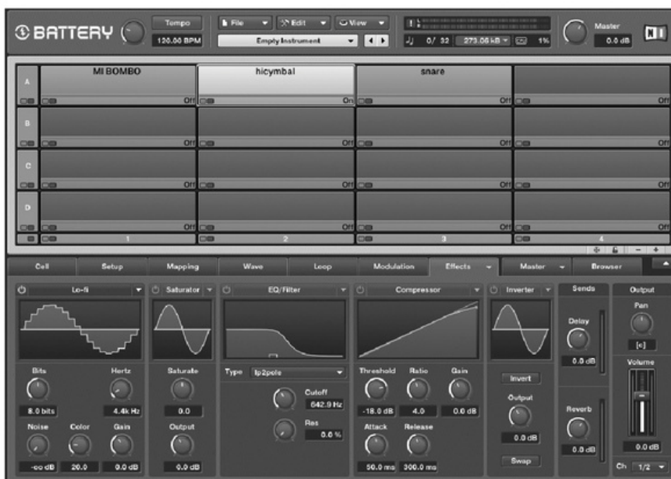
Figura 15. El efecto Lo-fi ha sido activado en la celda. Se trata de un efecto que baja la calidad de la reproducción de la muestra para obtener un sonido viejo y sucio.
