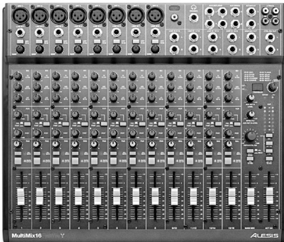
Figura 21. Alesis MultiMix16 es una placa de sonido externa en formato de mezcladora que permite grabar 16 canales en simultáneo en nuestra computadora.
