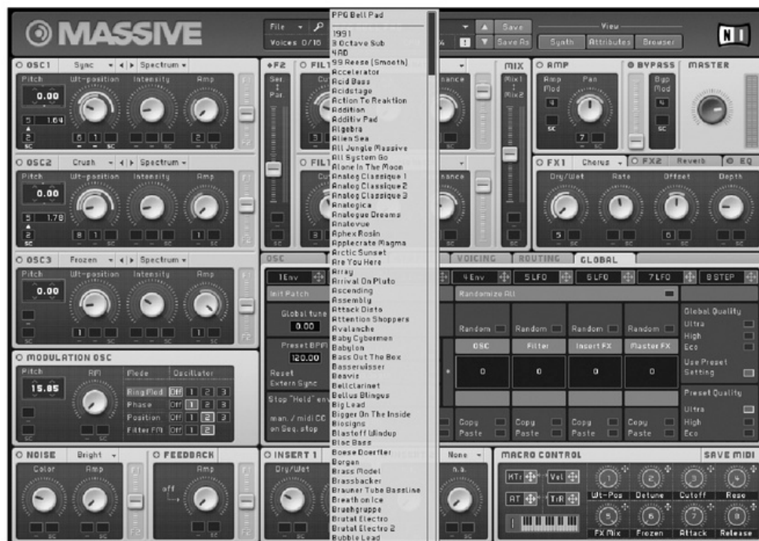
Figura 10. Para acceder a un sonido, simplemente hacemos clic sobre él. Veremos que los controles de Massive se reajustan para que el sintetizador genere el nuevo sonido.
