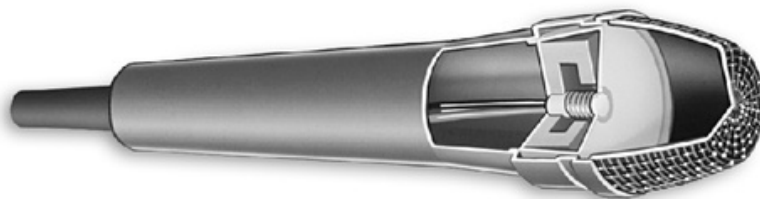
Figura 1. En este esquema de corte, pueden identificarse claramente, pero de manera simplificada, los componentes de un micrófono.
