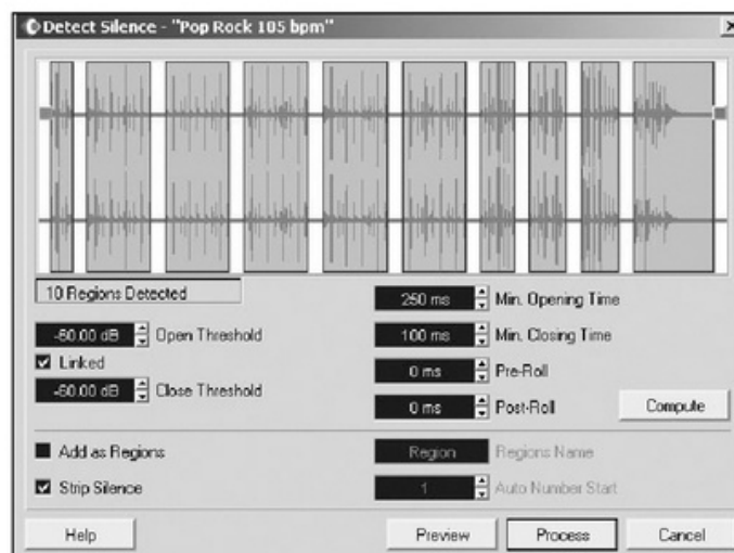
Figura 7. La función Detect Silence (detectar silencios) de Cubase selecciona en forma automática los pasajes del archivo de audio que contienen silencios.
