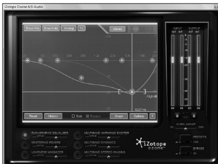
Figura 23. Con el ecualizador paragráfico, podremos controlar el balance tonal general de la mezcla.
