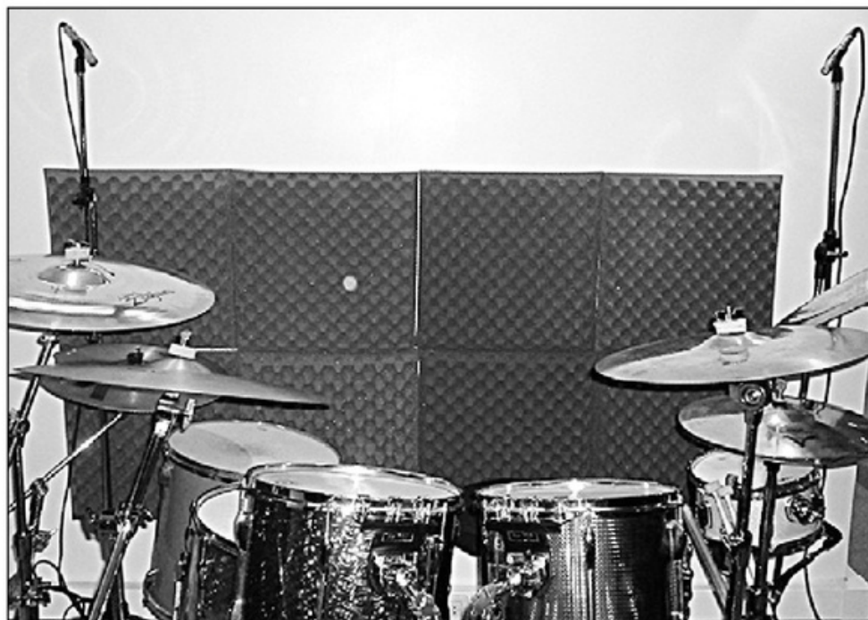
Figura 23. El par espaciado suele usarse con micrófonos omnidireccionales para capturar ensambles, coros y baterías.
