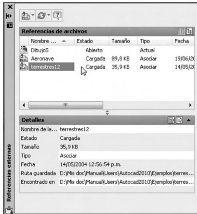
**Figura 11.** Al pulsar sobre una referencia visualizamos sus detalles en la parte inferior de la paleta.
