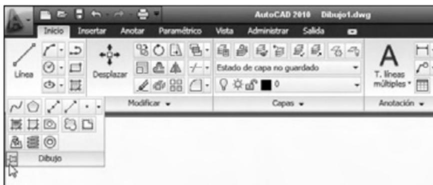
**Figura 6.** Mediante el botón señalado en esta imagen, las opciones del grupo se muestran siempre visibles. Para desactivarlo debemos pulsarlo nuevamente.
