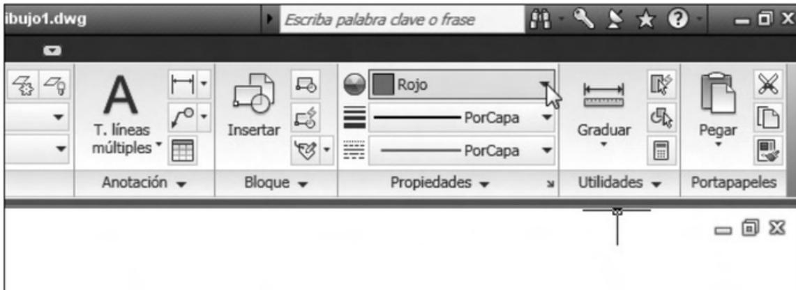
**Figura 8.** Debemos desplegar la lista y seleccionar el color que deseamos aplicar a los elementos seleccionados.
