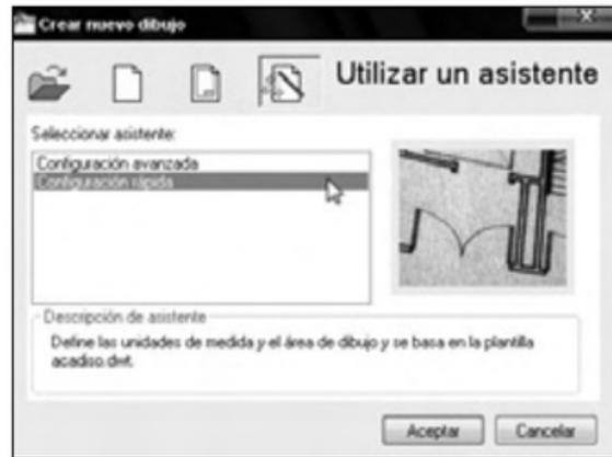
**Figura 13.** Mediante la opción *Utilizar asistente* podemos acceder a un asistente avanzado o de configuración rápida.
