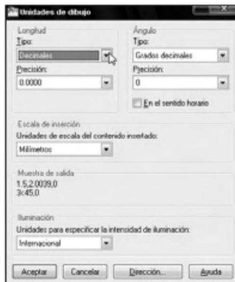
**Figura 14.** En la lista *Tipo* del apartado *Longitud* establecemos el sistema de medida para el dibujo.
