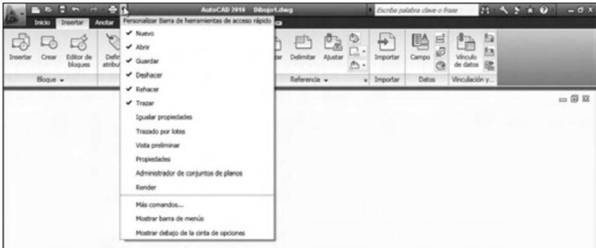
**Figura 5.** A través del botón *Personalizar Barra de herramientas de acceso rápido* podemos activar o desactivar los botones que deseamos que se muestren u oculten en la barra.
