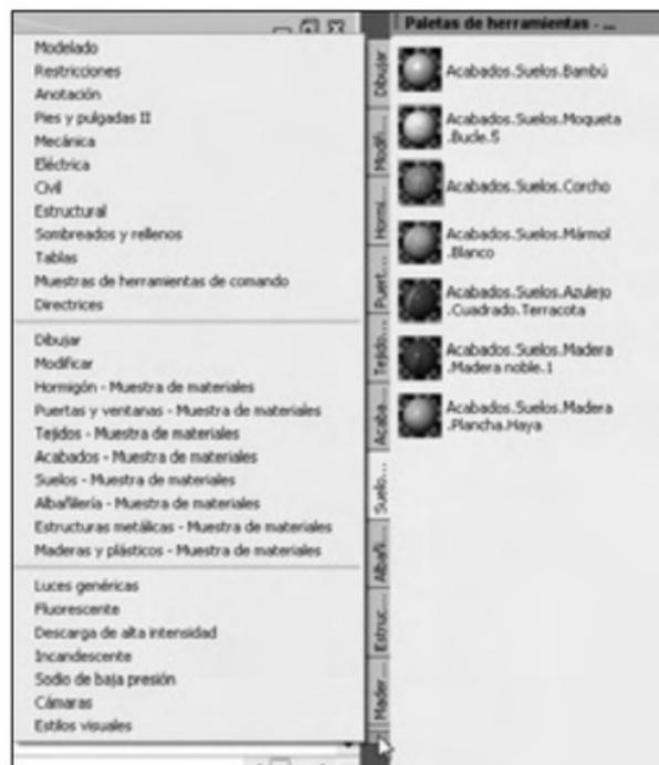
**Figura 1.** Para desplegar el menú de paletas debemos pulsar sobre el elemento señalado en la parte inferior de la paleta.
