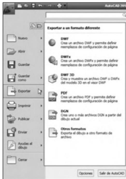
**Figura 4.** El comando *Exportar* permite guardar el dibujo en diferentes formatos que sean compatibles con otros programas.
