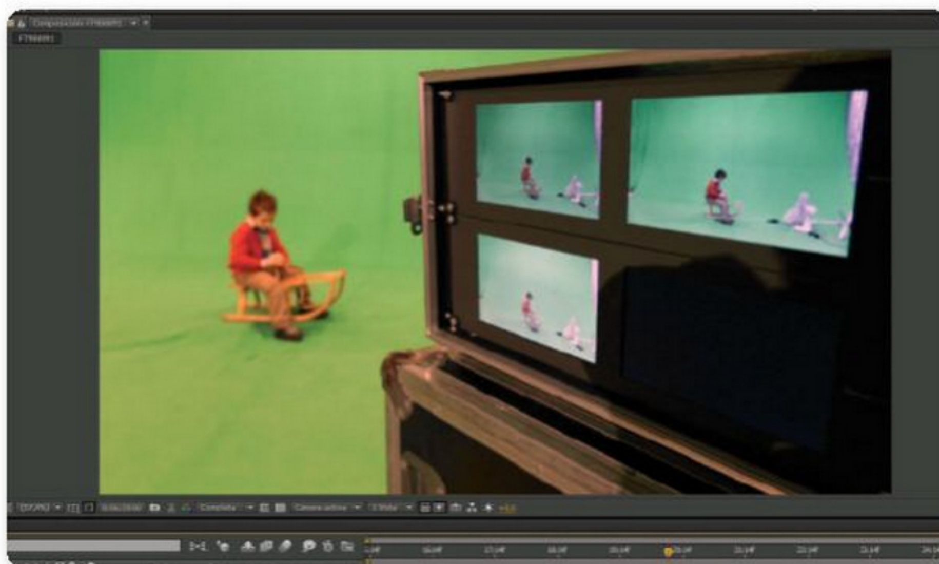
Figura 8. La técnica en la que se reemplaza un fondo de color con otras capas se denomina incrustación de color o de croma o llave de color .
