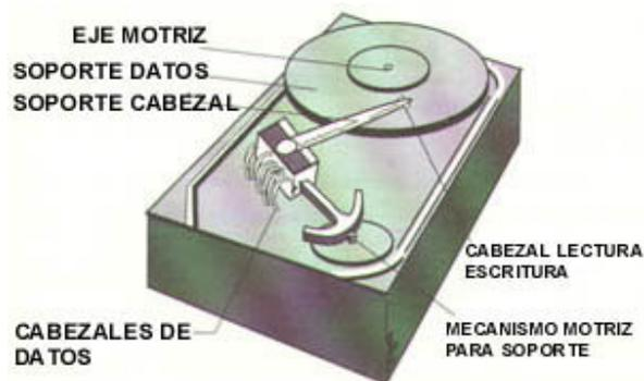
Partes fundamentales de un disco duro :
