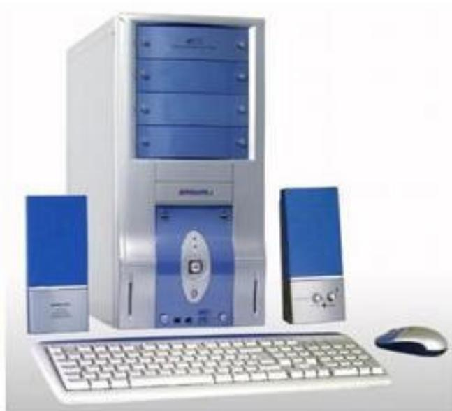
Vemos en la imagen una torre con cuatro racks de 5 $\frac{1}{4}$  y 2 rackss de 3 $\frac{1}{2}$  externos . A su vez hay espacio para pensar que existe un rack mas de 3 $\frac{1}{2}$  interno.
