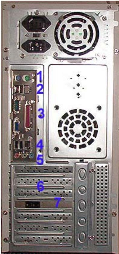
Vemos la parte posterior de un gabinete ATX , observe como todos los conectores estan juntos , justamente este gabinete se diseño para que entre otras funciones permitiera agrupar los conectores. Vemos
