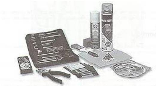
Además como vemos en la figura pueden ser útiles una **aerosol de aire comprimido** para limpiar , **cotonetes de algodón** para limpiar disqueteras, cdroms, etc , **un pincel de limpieza** para limpiar el gabinete , **un fieltro o paño** de limpieza , caja con tornillos y arandelas .
