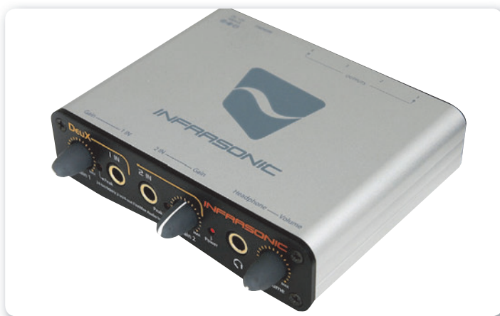
Figura 23. Interfaz de audio semiprofesional externa, de conexión FireWire, óptima para grabar voces y un instrumento acústico.
