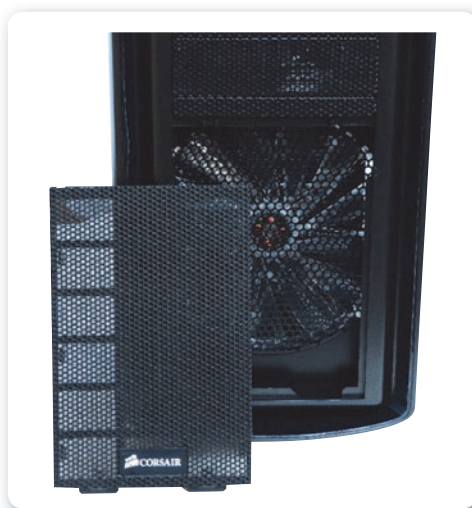
Figura 13. Algunos gabinetes traen una doble rejilla frontal para evitar el ingreso de polvillo.
