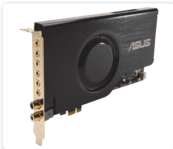
Figura 20. Placa de audio de gama alta que incluye entradas y salidas digitales ópticas.
