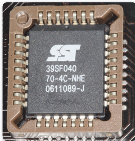
Figura 6. Uno de los posibles formatos adoptados por los fabricantes para el chip del BIOS, encastrado en su zócalo.
