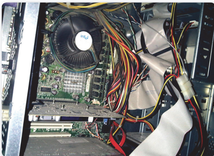
Figura 5. Como podemos apreciar, el flujo de aire no se logra en forma adecuada por la mala organización de los cables.
