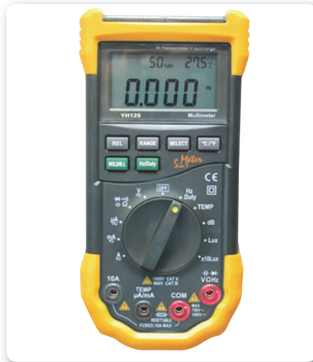
Figura 7. El multímetro nos ayuda en la revisión periódica de la fuente de poder.
