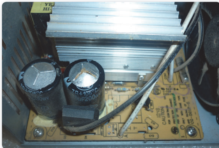
Figura 26. En esta imagen podemos observar el daño en una fuente ATX, provocado por una sobretensión.
