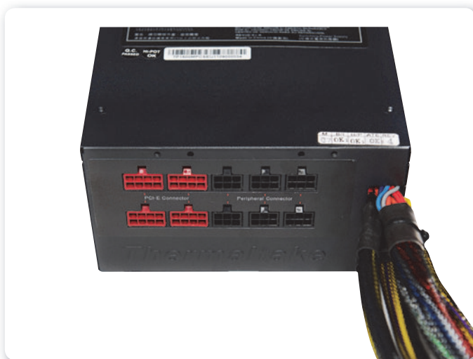
Figura 14. Conectores presentes en esta fuente semimodular: 4 salidas PCI-E, y 6 para S-ATA y demás periféricos.
