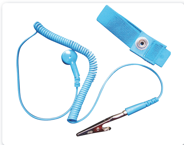
Figura 2. De nada sirve el mantenimiento si no prevenimos el daño que nuestro cuerpo puede ocasionar en el hardware.
