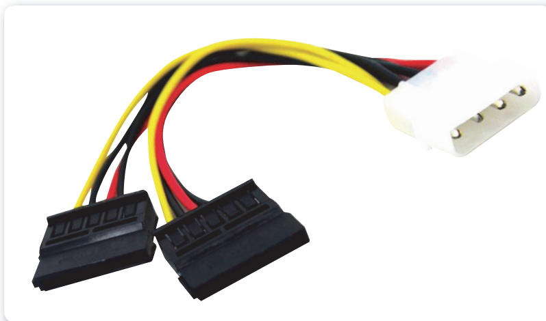
Figura 10. No todas las fuentes traen la cantidad de conectores SATA necesarios, por lo que existen adaptadores de Molex a SATA Power.
