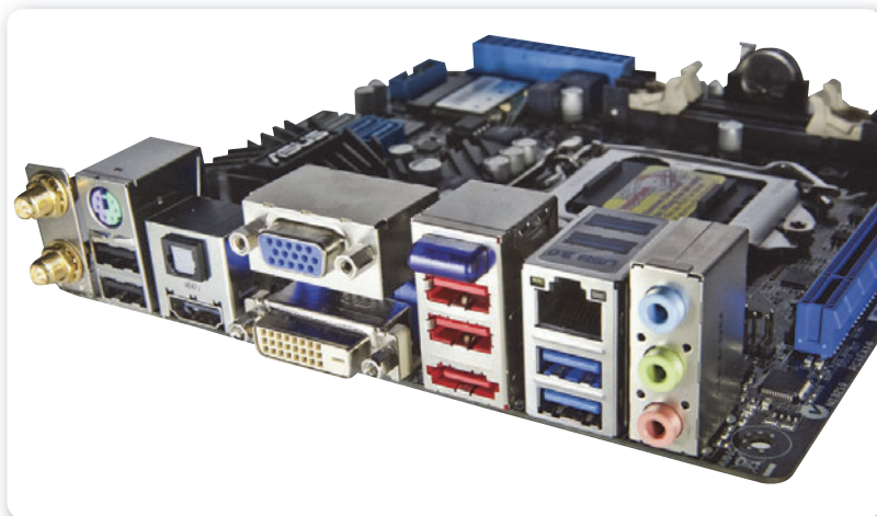
Figura 19. A pesar de ser un pequeño motherboard de formato ITX, este modelo posee múltiples interfaces.
