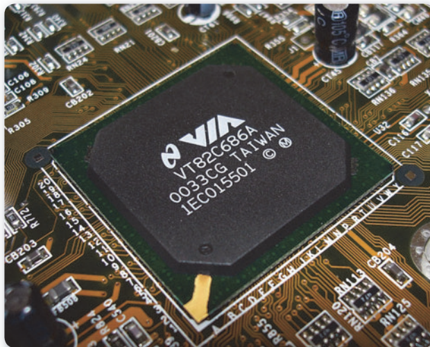
Figura 17. Chip del fabricante VIA que no requiere disipación de calor por mantenerse en márgenes seguros.
