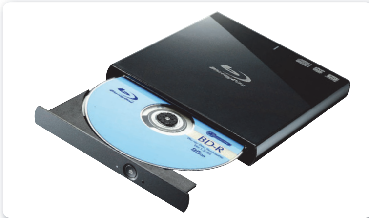
Figura 21. En la imagen vemos una típica unidad Blu-ray. Se trata de un dispositivo externo que se conecta a la PC mediante un cable USB.
