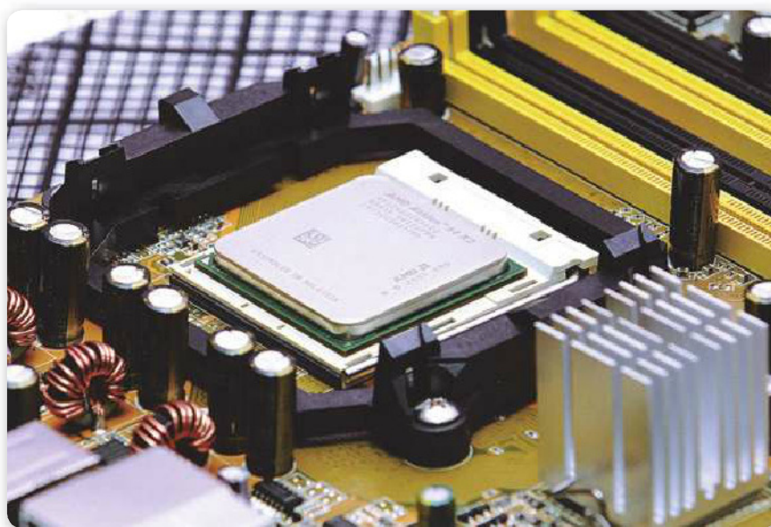
Figura 1. En la imagen vemos cómo queda un procesador instalado en un motherboard compatible.
