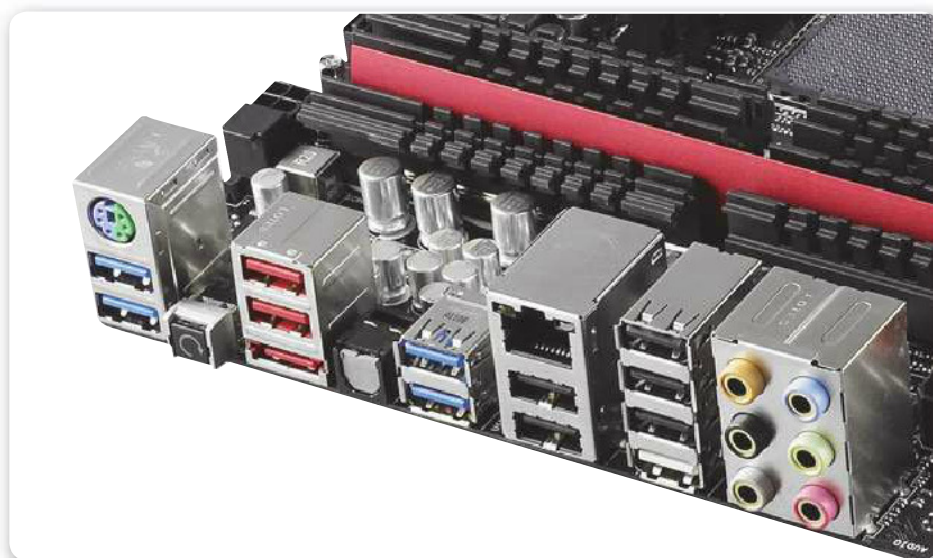
Figura 20. Los modelos de gama alta ofrecen todo tipo de puertos integrados para maximizar la conectividad.
