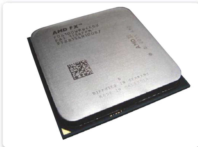
Figura 12. El AMD FX-6100 cuenta con seis núcleos a una frecuencia real de 3,3 GHz.
