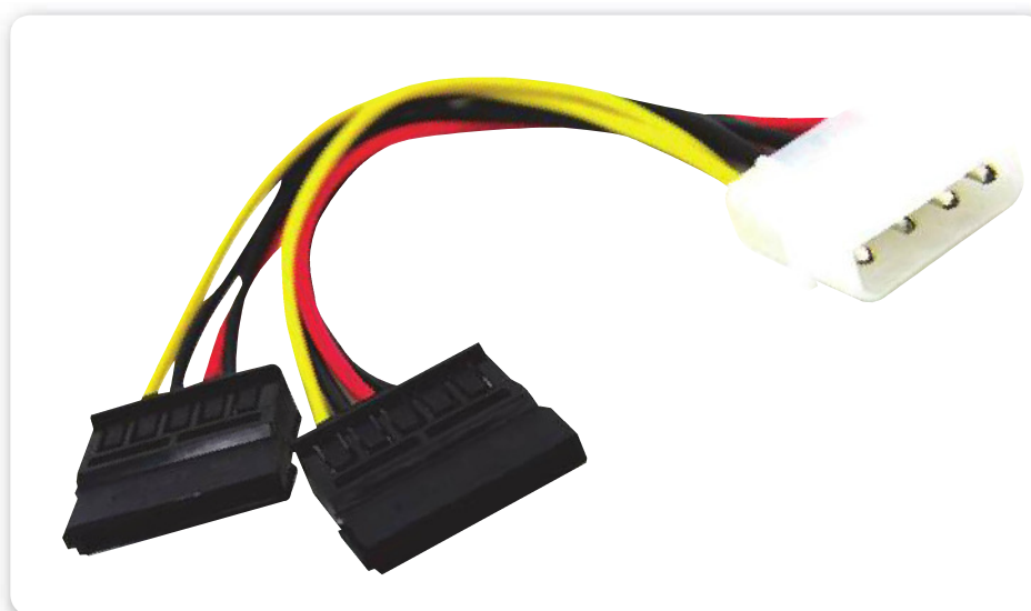
Figura 10. No todas las fuentes traen la cantidad de conectores SATA necesarios, por lo que existen adaptadores de Molex a SATA Power.
