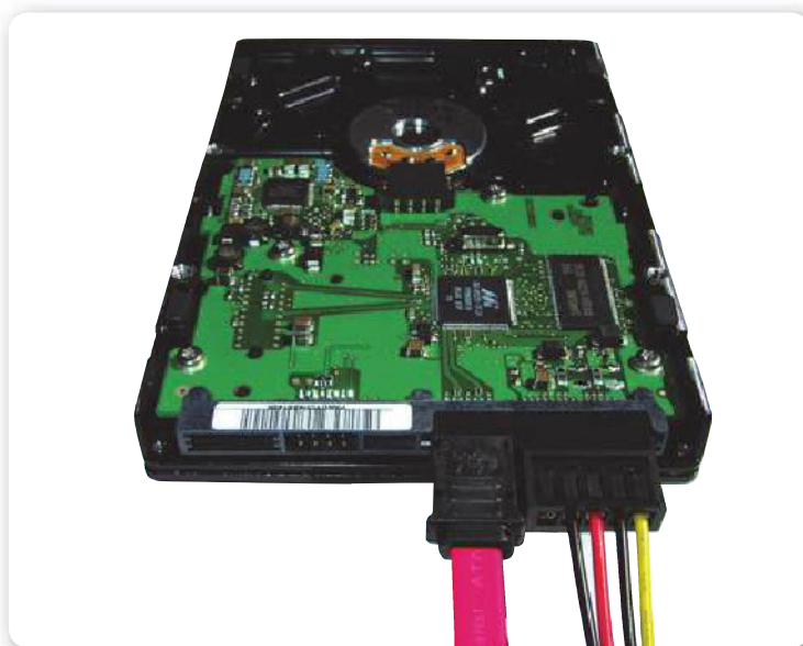
Figura 8. La conexión de discos duros Serial ATA es mucho más simple que en discos Parallel ATA, porque no se requiere configurar jumpers.
