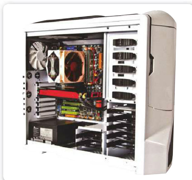
Figura 12. Notemos cómo, a los efectos organizativos, la fuente fue instalada en la base del gabinete.
