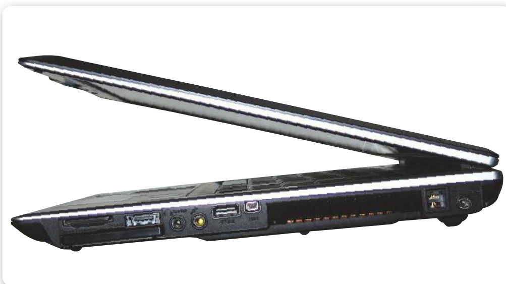
Figura 18. En la imagen, vemos un equipo portátil con diversos puertos de conexión (eSATA / USB).
