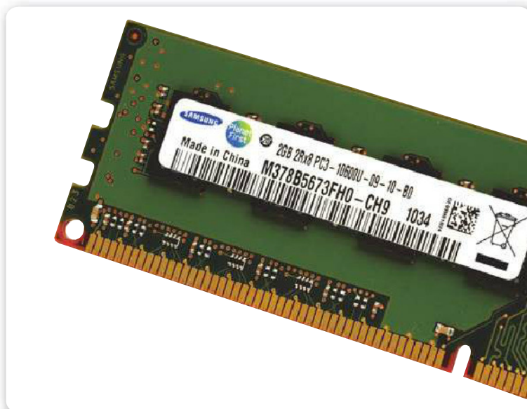
Figura 11. Los fabricantes acostumbran a poner un rótulo con las características de cada módulo de memoria.
