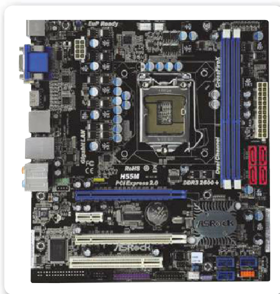
Figura 8. Típico motherboard de gama media, fácilmente identificable por la cantidad de zócalos de memoria y de expansión.
