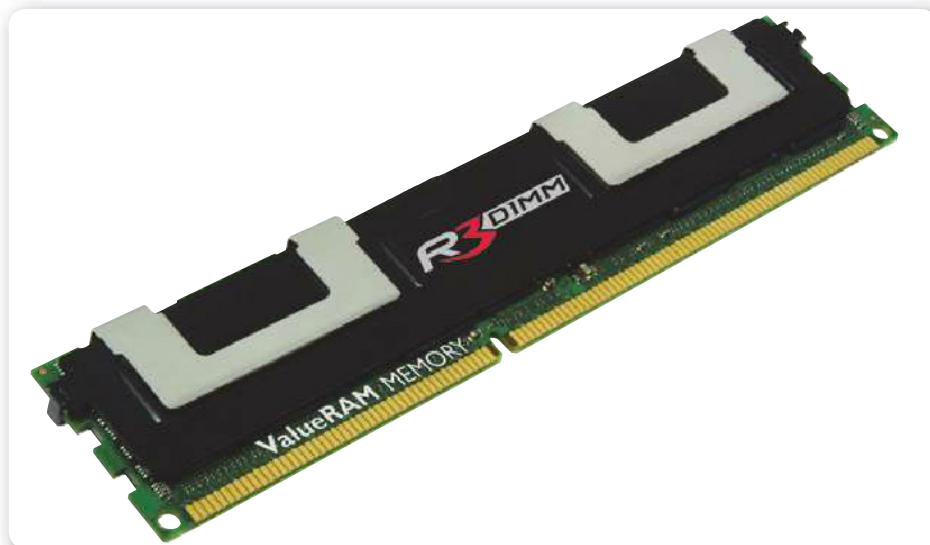
Figura 12. Los circuitos ECC aseguran la integridad constante de los datos de la memoria RAM.
