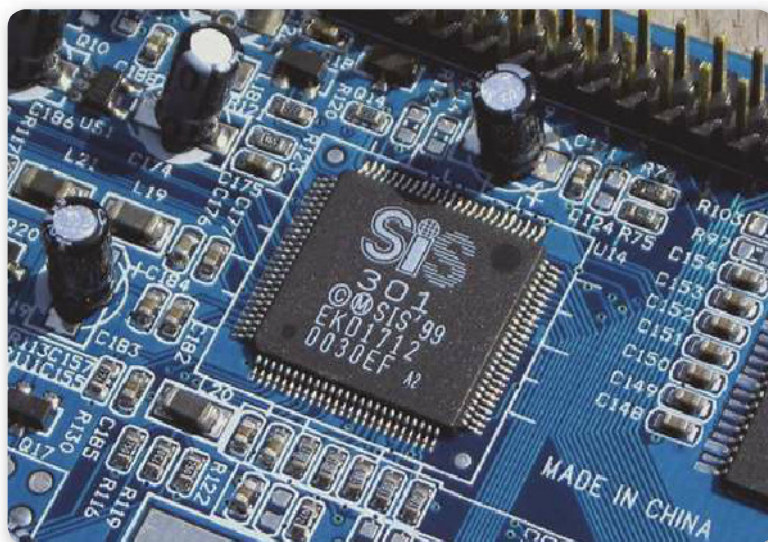
Figura 25. El chip de video es uno de los primeros que debemos proceder a comprobar.
