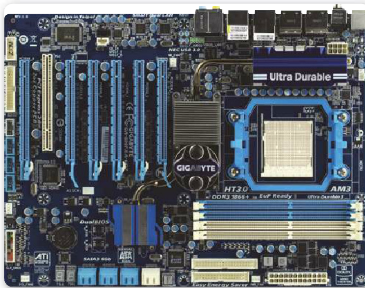
Figura 2. Ciertos modelos de motherboard ofrecen una cantidad enorme de zócalos PCI Express.
