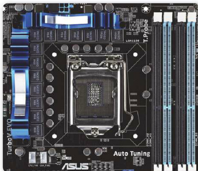
Figura 9. El socket del procesador es el que define la compatibilidad con el motherboard y, por lo tanto, con el chipset.
