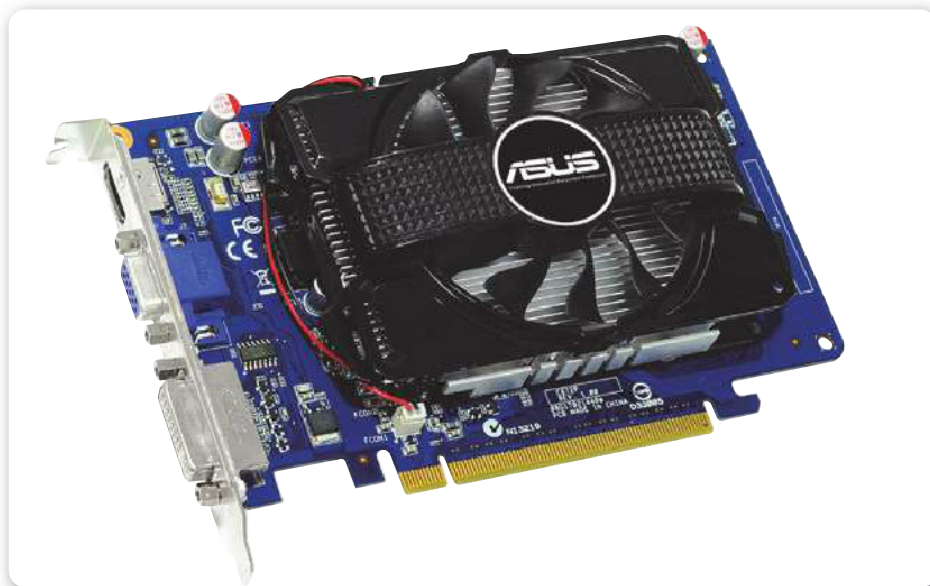
Figura 4. Tarjeta gráfica del fabricante ASUS, con una GPU de NVIDIA, que posee salidas VGA, DVI y HDMI.
