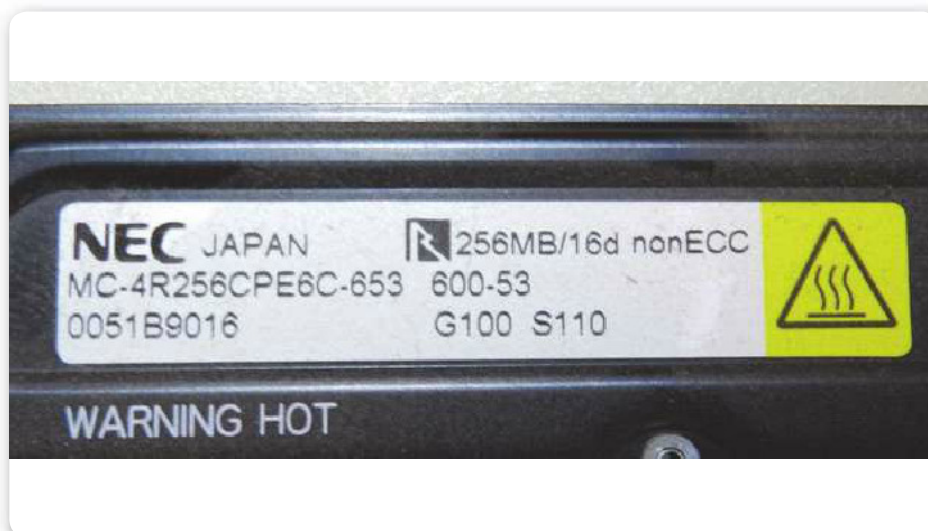
Figura 7. Este módulo RIMM de NEC incluía la advertencia WARNING-HOT, debido a su excesivo calentamiento.
