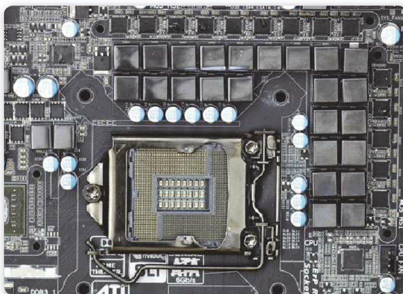
Figura 3. El VRD, o módulo regulador de tensión, se ubica alrededor del zócalo del microprocesador.
