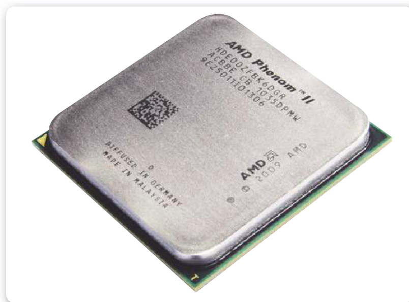
Figura 3. En este caso, vemos un ejemplo de un procesador actual de AMD: un Phenom II.
