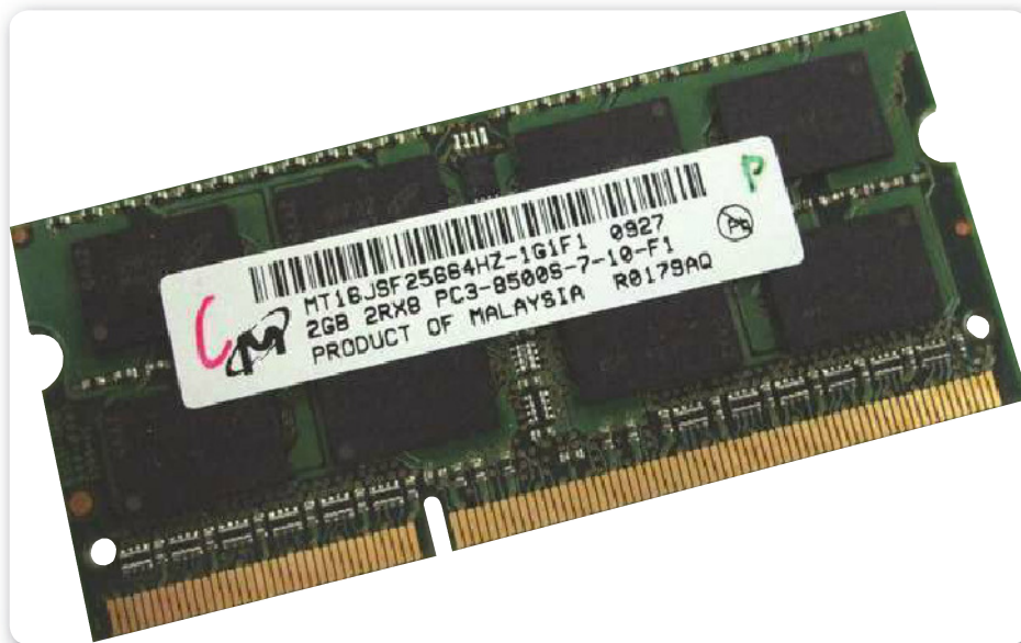
Figura 8. A simple vista, los módulos SO-DIMM resultan mucho más compactos que sus contrapartes de escritorio.
