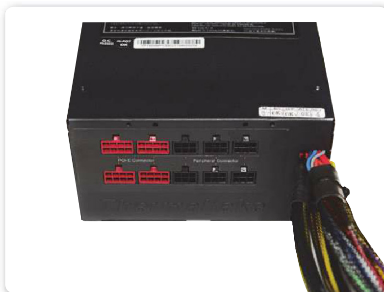
Figura 14. Conectores presentes en esta fuente semimodular: 4 salidas PCI-E, y 6 para S-ATA y demás periféricos.
