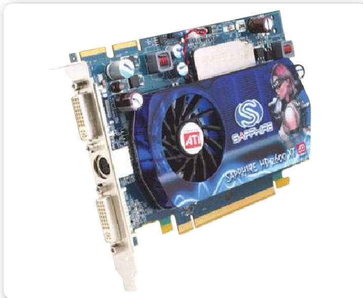
Figura 5. Esta placa de gama baja del fabricante ATI posee dos salidas DVI y una S-Video (TV Out).
