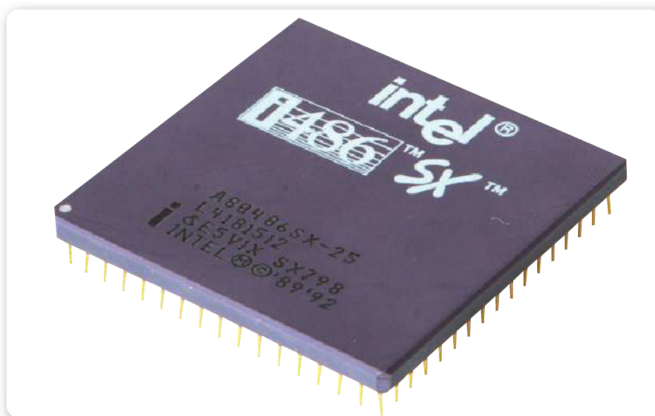
Figura 6. El Intel 486SX tenía la particularidad de no poseer FPU (unidad de punto flotante).
