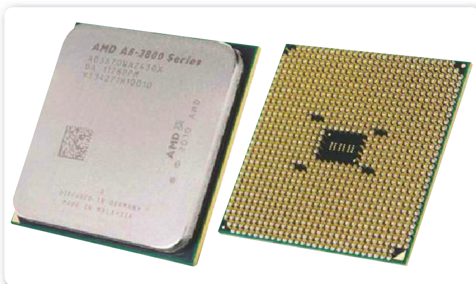
Figura 11. Este procesador posee una GPU integrada: es un Radeon HD 6550D.
