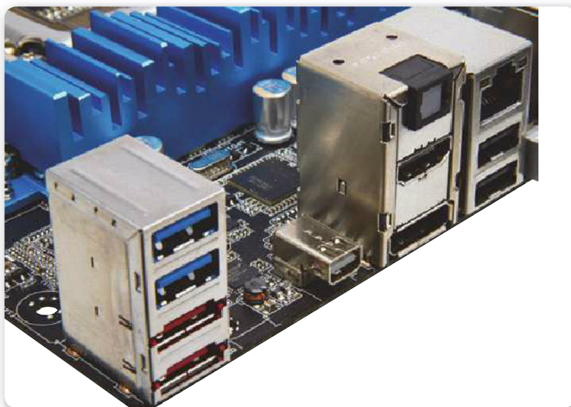
Figura 22. Motherboard de última generación que incluye un puerto Thunderbolt, útil para conectar a un monitor.
