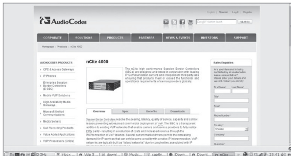
Figura 14. El nCite 4000, de Audiocodes, es un equipo que, entre otras cosas, provee seguridad para las comunicaciones VoIP, con capacidades de encriptación, protección contra ataques DoS, validación de protocolos y muchas otras funciones.
