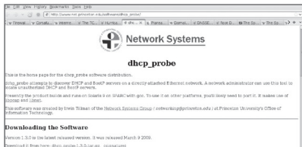
Figura 25. La herramienta DHCP-Probe ( www.net.princeton.edu/software/dhcp_probe ) nos permite detectar los servidores DHCP que se encuentran en una red local. Es de mucha utilidad para detectar servidores que no deberían estar ahí.
