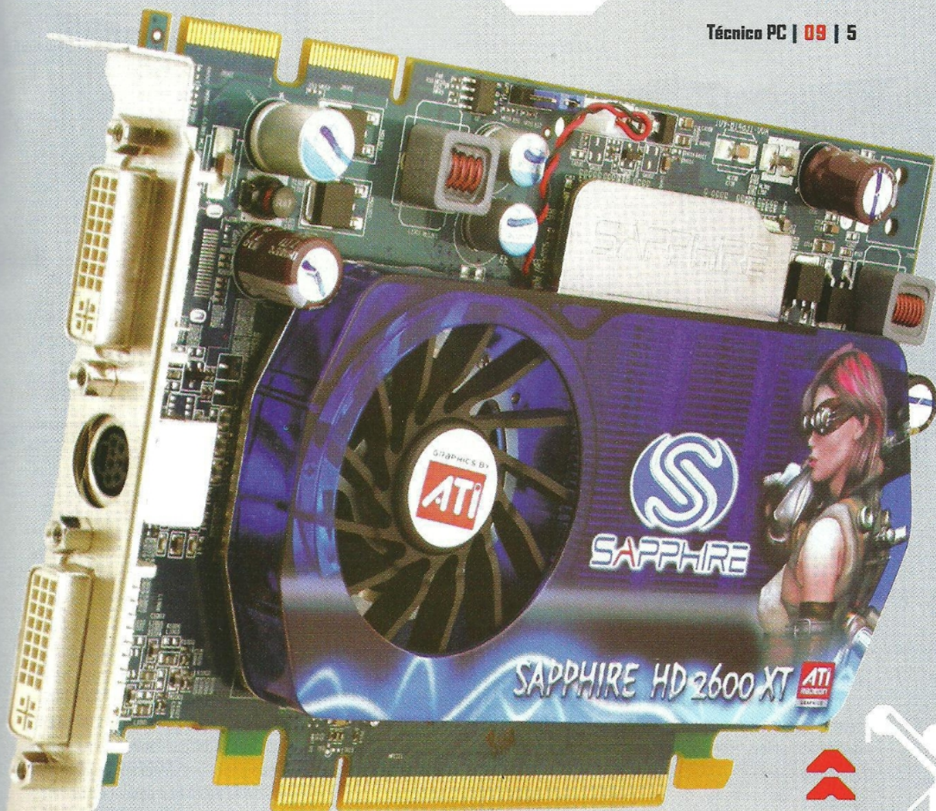
Dual VGA. Esta placa de gama baja del fabricante ATI posee dos salidas DVI y una S-Video (TV Out).
