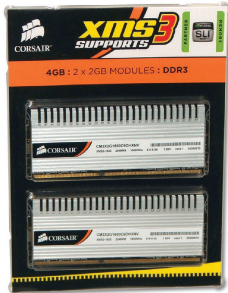
Figura 11. Módulos de memoria RAM con disipadores de calor incorporados de fábrica.
