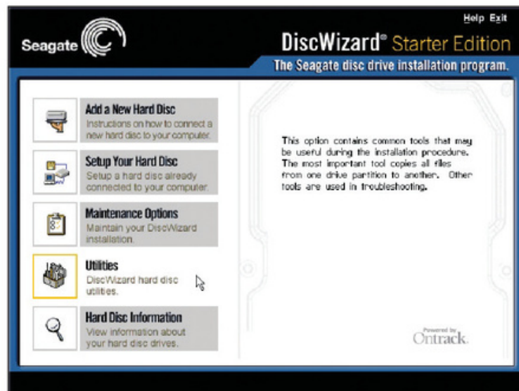
Figura 18 DiscWizard es la aplicación booteable que provee Seagate para diagnosticar sus unidades de disco.
