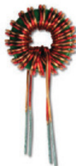
Figura 4. Típica bobina inductora encontrada en motherboards y fuentes de energía.
