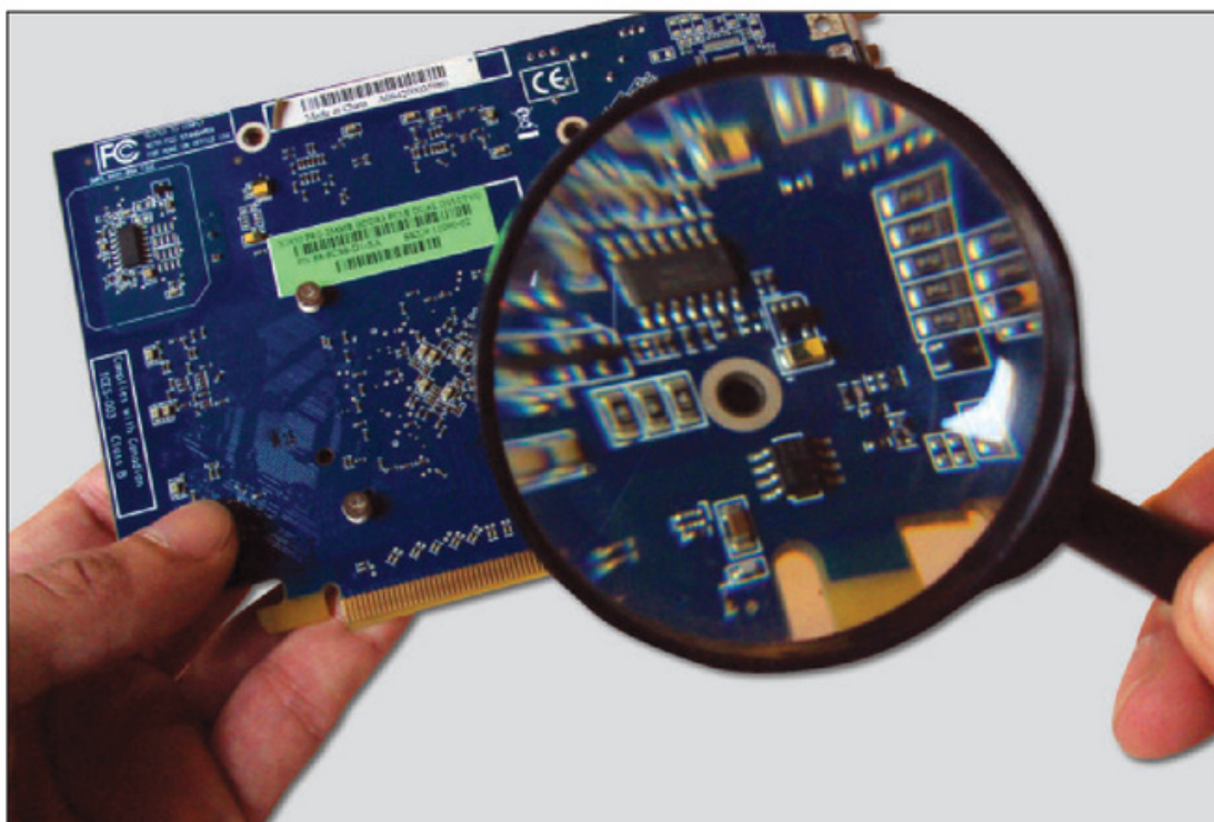
Figura 4. Para observar en detalle si algún componente electrónico está dañado o las pistas de una placa están cortadas, es aconsejable emplear una lupa y buena iluminación.
