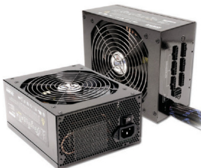
Figura 18. Fuente semimodular de gran calidad para equipos de alta gama.
