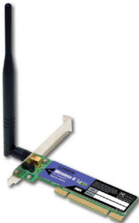
Figura 11. Tarjeta WiFi 802.11g en formato PCI, que incluye una antena de gran potencia y amplio alcance.
