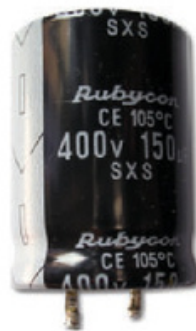
Figura 3. Capacitor electrolítico. Se trata de un repuesto económico que se adquiere indicando su valor de tensión máxima (volts) y su capacitancia ( \mu F ). El borne negativo se indica con la franja blanca.
