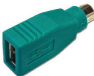
Figura 2. Los adaptadores de USB a PS/2 permiten conectar mouse USB en puertos PS/2.
