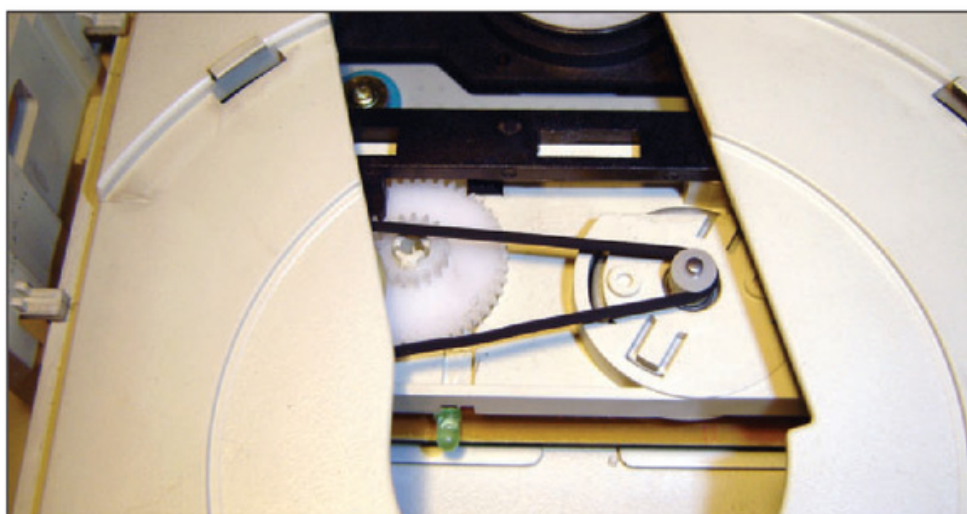
Figura 35. La correa, de color negro, transmite el movimiento desde el motor hacia la bandeja portadiscos. Al retirar la bandeja, se puede retirar la correa y conseguir el reemplazo en tiendas especializadas.
