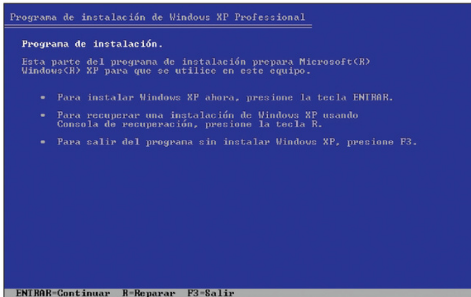
Figura 5. Al iniciar el equipo con el disco de instalación de Windows XP, aparece el menú que nos permite ingresar en la Consola de recuperación al pulsar la tecla R .
