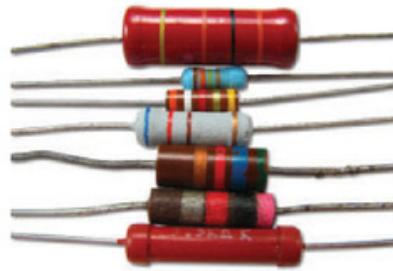
Figura 2. Resistores de todo tipo y tamaño. Las franjas de colores indican su valor en Ohms.
