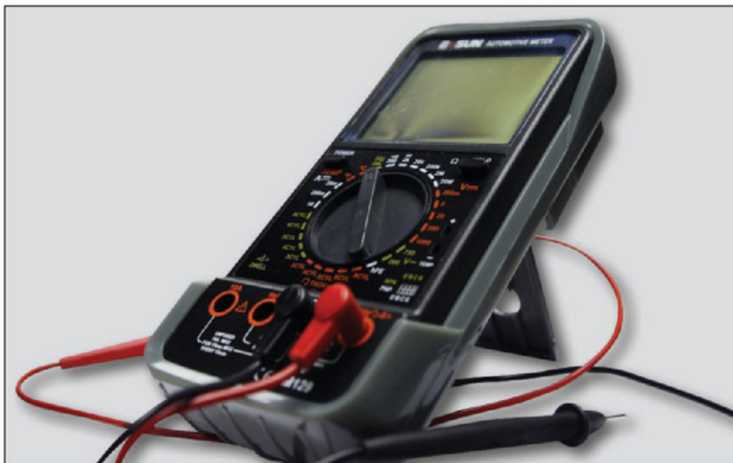
Figura 7. El multímetro es una de las herramientas imprescindibles a la hora de encarar una PC en problemas.
