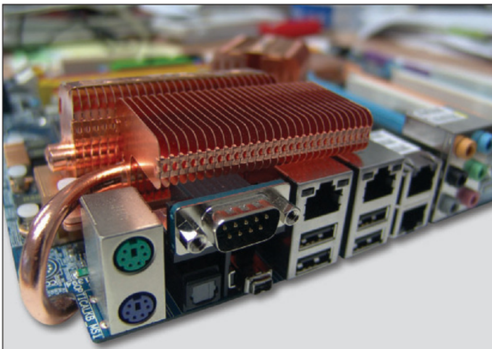
Figura 5. Motherboard de alta gama, que utiliza un sistema de heat-pipes para refrigerar el northbridge y el regulador de tensión.
