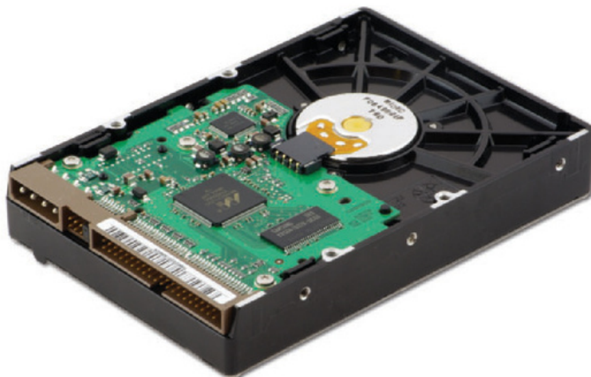
Figura 2. Disco duro de interfaz Parallel-ATA, método de conexión anterior al Serial-ATA.
