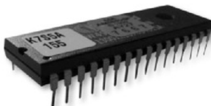
Figura 10. Clásico formato de un chip de BIOS. En la actualidad, tienen la mitad de este tamaño, y sus patas no corren riesgo de romperse.
