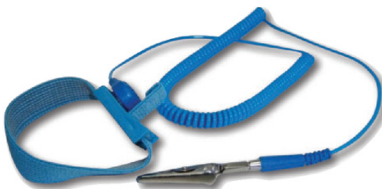
Figura 8. El uso de una pulsera antiestática no es obligatorio, pero sí muy recomendable. En ambientes donde hay alfombras, es indispensable colocársela ya que nos cargaremos fácilmente, y se producirán descargas electrostáticas con solo tocar los dispositivos.
