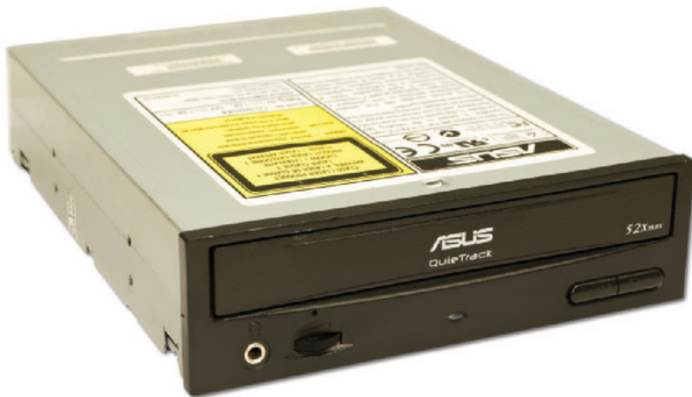
Figura 34. Unidad óptica del fabricante ASUS ; su lente láser suele ensuciarse y descalibrarse tarde o temprano.
