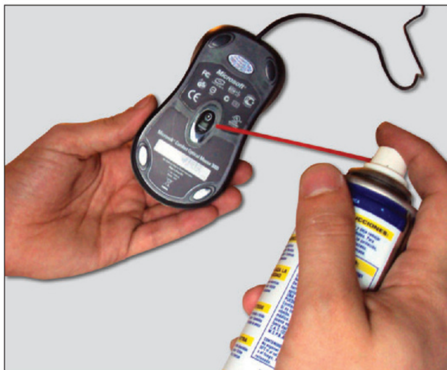
Figura 4. Es necesario limpiar el emisor de luz del mouse con removedor de partículas, en forma periódica.
