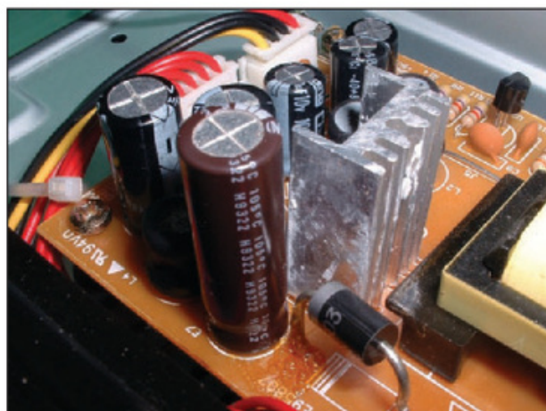
Figura 31. Etapa primaria de una minifuentes de alimentación: es aquí donde siempre se alojan los capacitores y diodos de gran tamaño.
