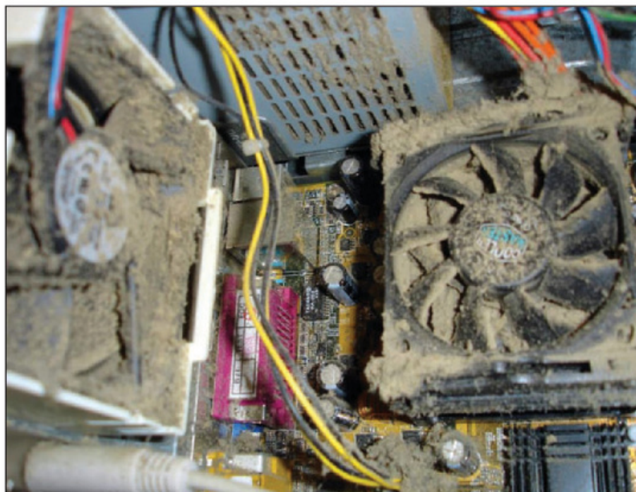
Figura 6. La suciedad cubre, casi por completo, los orificios de entrada de aire en la fuente de alimentación.
