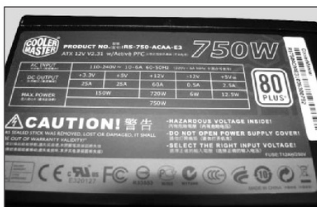
Figura 14. Las fuentes de energía traen, en uno de sus laterales, una etiqueta con sus especificaciones técnicas: amperes por rail, potencia por rail y potencia total.
