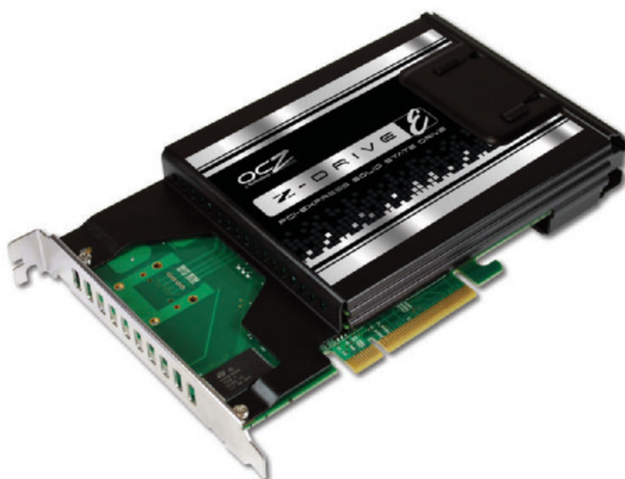
Figura 3. Unidad de estado sólido de interfaz PCI-Express 8x. Al no utilizar el bus Serial-ATA e introducir uno propio, se logran velocidades de transferencia del orden de los 500 MB/s, tanto en lectura como en escritura de datos.
