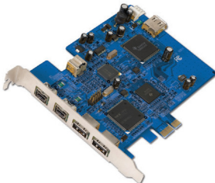
Figura 13. Tarjeta PCI-Express que ofrece puertos USB 2.0 y FireWire 800, tanto internos como externos.
