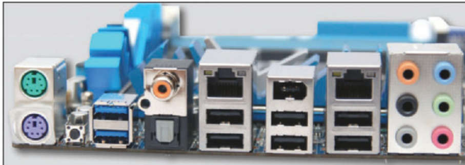
Figura 8. Panel trasero de un motherboard de gama alta: 2 PS/2, 2 USB 3.0, 6 USB 2.0 y 1 FireWire 400.
