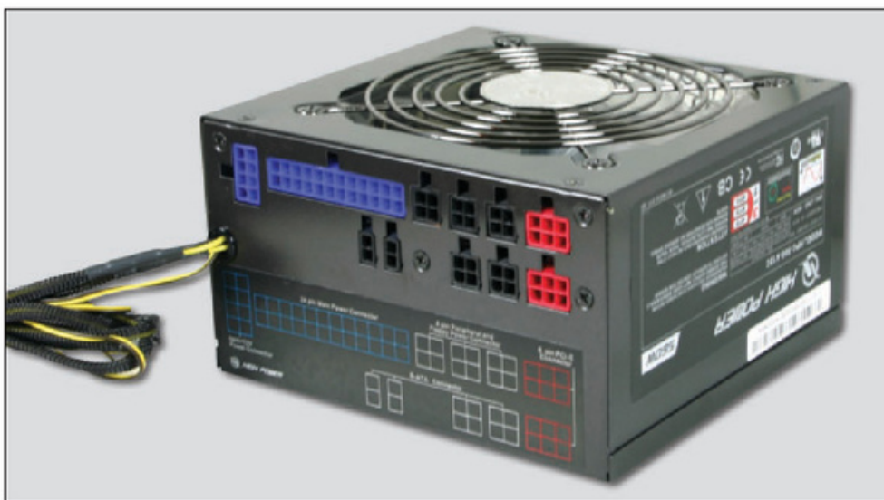
Figura 16. Fuente semimodular de última generación. Estos modelos permiten conectar solo los cables que van a ser efectivamente usados.
