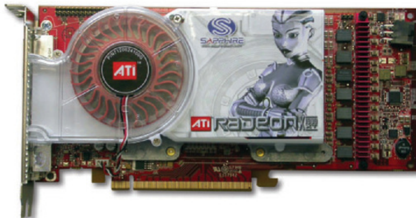
Figura 7. Una tarjeta gráfica dañada no enviará señal hacia el monitor. Uno de los puntos para comprobar implica el cambio provisorio de esta placa.
