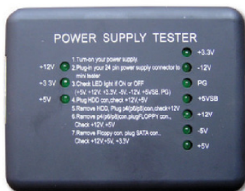
Figura 25. Pequeño tester digital para medir las líneas de tensión de todos los conectores de una fuente moderna. Es liviano y cabe en el bolsillo. En sus lados, posee zócalos para fichas ATX24, Molex, Berg, Serial-ATA, EPS y PCIe.
