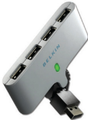
Figura 6. Hub USB 2.0 permite convertir un puerto USB en cuatro; ideal para cuando escasea este tipo de puertos en nuestra PC.
