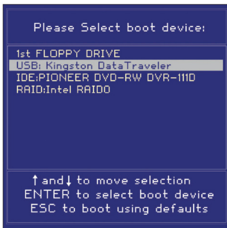
Figura 19. Menú de booteo BBS que aparece al pulsar F10 o F11 durante el POST en BIOS del fabricante AMI.
