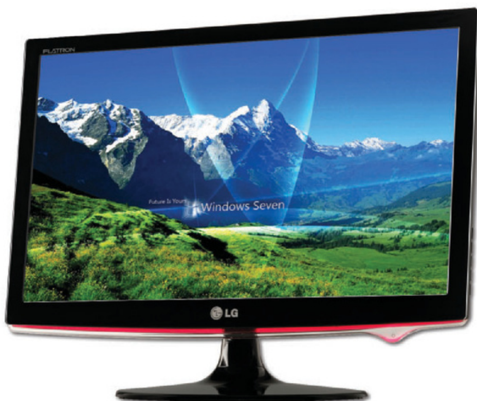
Figura 6. A diferencia de los obsoletos monitores de tubo de rayos catódicos, los paneles LCD presentan menos problemas y una vida útil unas cuatro veces mayor.
