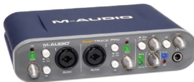
Figura 12. Interfaz de audio externa USB 2.0. Su poder de procesamiento es mayor que las tarjetas comunes, ya que cubren el segmento semiprofesional.
