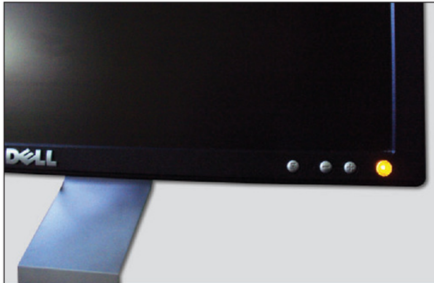
Figura 2. La luz naranja en el LED de los monitores indica que éste no está recibiendo señal desde la tarjeta gráfica.
