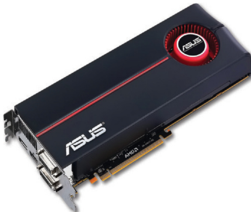
Figura 1. Tarjeta gráfica PCI-Express 2.0 del fabricante ASUS. Este tipo de placas permite ejecutar los juegos de gráficos más realistas con el mejor rendimiento.
