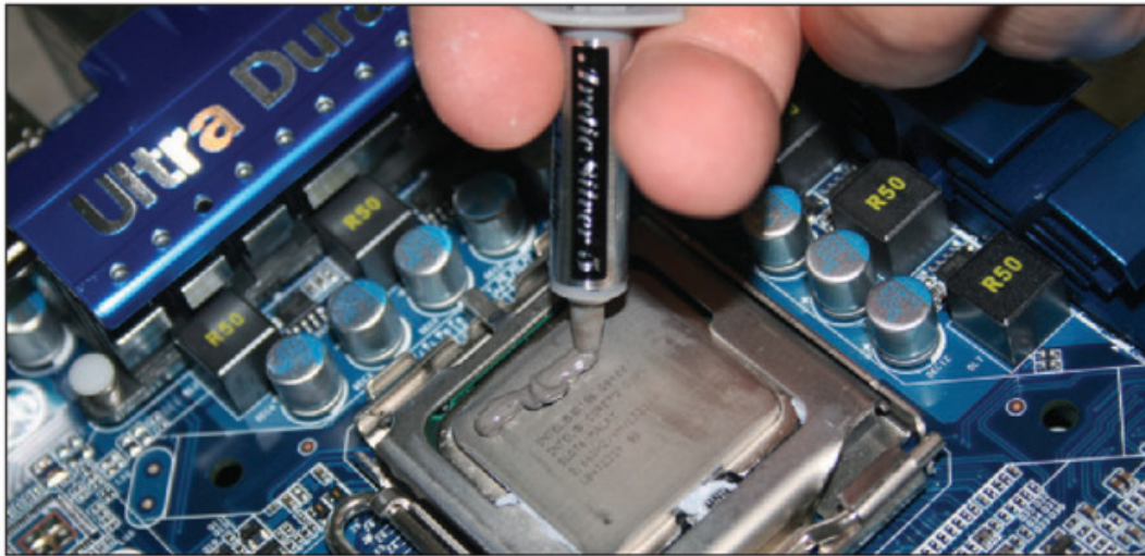
Figura 8. La pasta térmica Arctic Silver 5 es la elegida por los usuarios que practican overclocking , por su gran capacidad para transferir calor.
