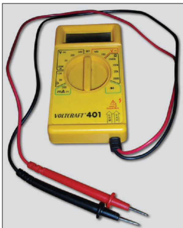
Figura 22. Multímetro básico, ideal para ser usado en reparación de computadoras porque cubre todas las necesidades a un costo muy escaso.
