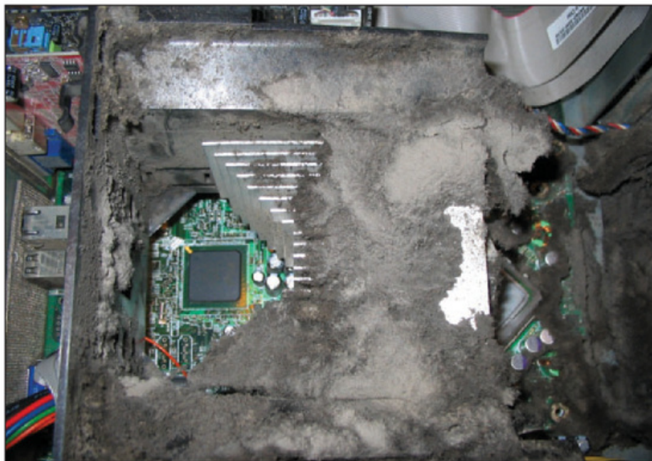
Figura 3. Acumulación extrema de polvo en el disipador de un procesador. En ambientes hostiles, como la industria, se deben redoblar las precauciones.
