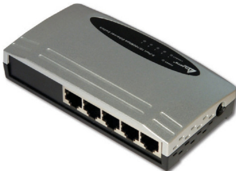
Figura 2. Pequeño switch de cinco puertos Ethernet de 100 Mbps, ideal para el hogar o la pequeña oficina.
