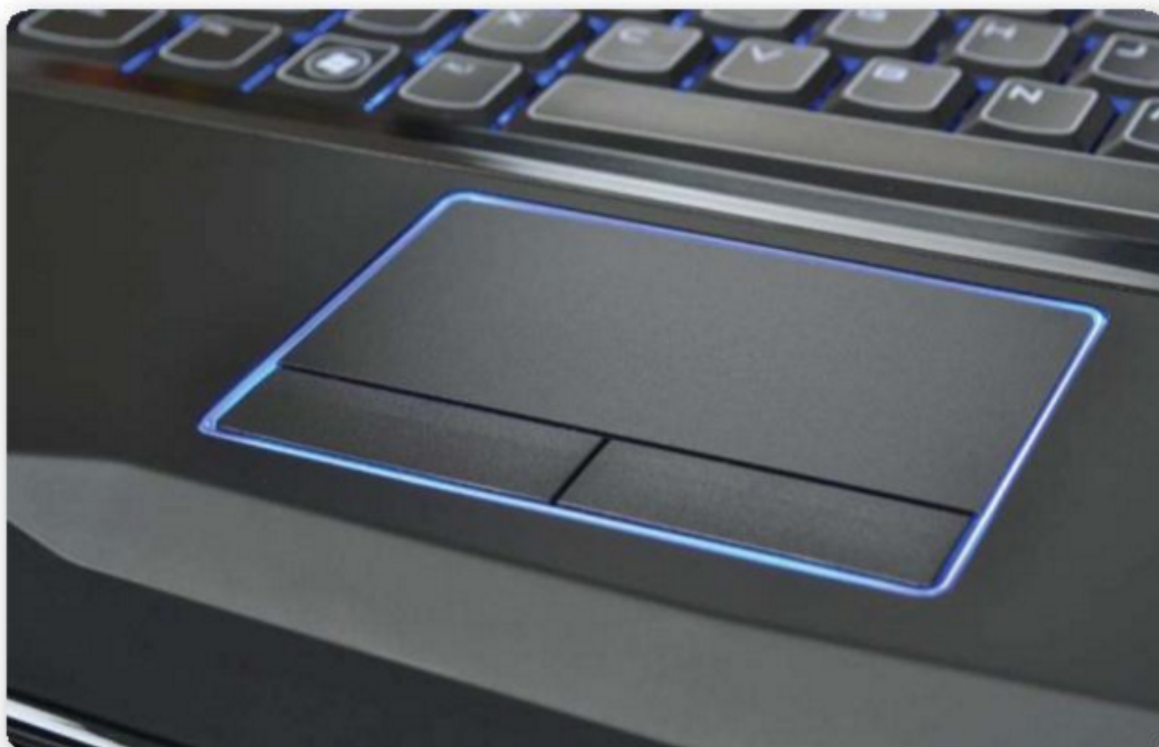
Figura 3. Detalle del touchpad de una notebook, donde se aprecian los dos botones debajo de su superficie.
