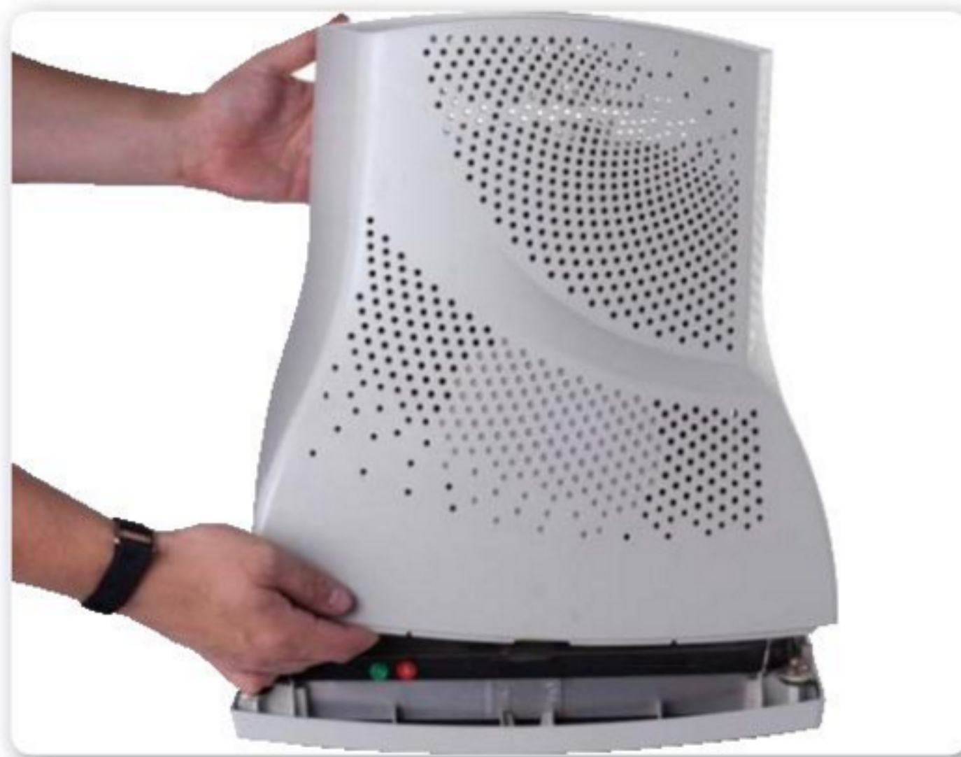
Figura 12. En la imagen podemos ver la forma en que se debe retirar la carcasa de un monitor.
