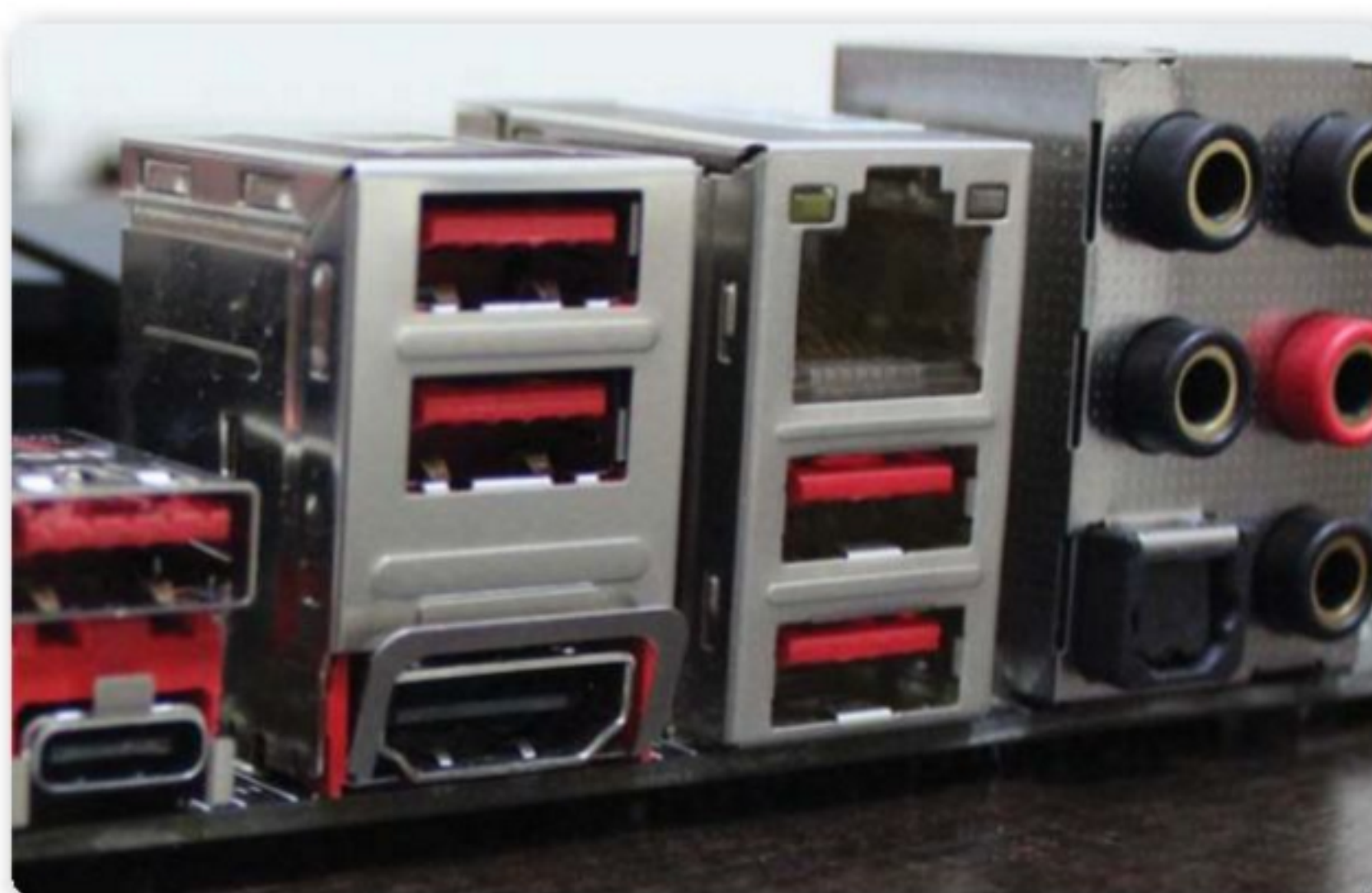
Figura 16. En redes cableadas, hay un puerto Ethernet para conectar por medio de fichas RJ-45 al motherboard.
