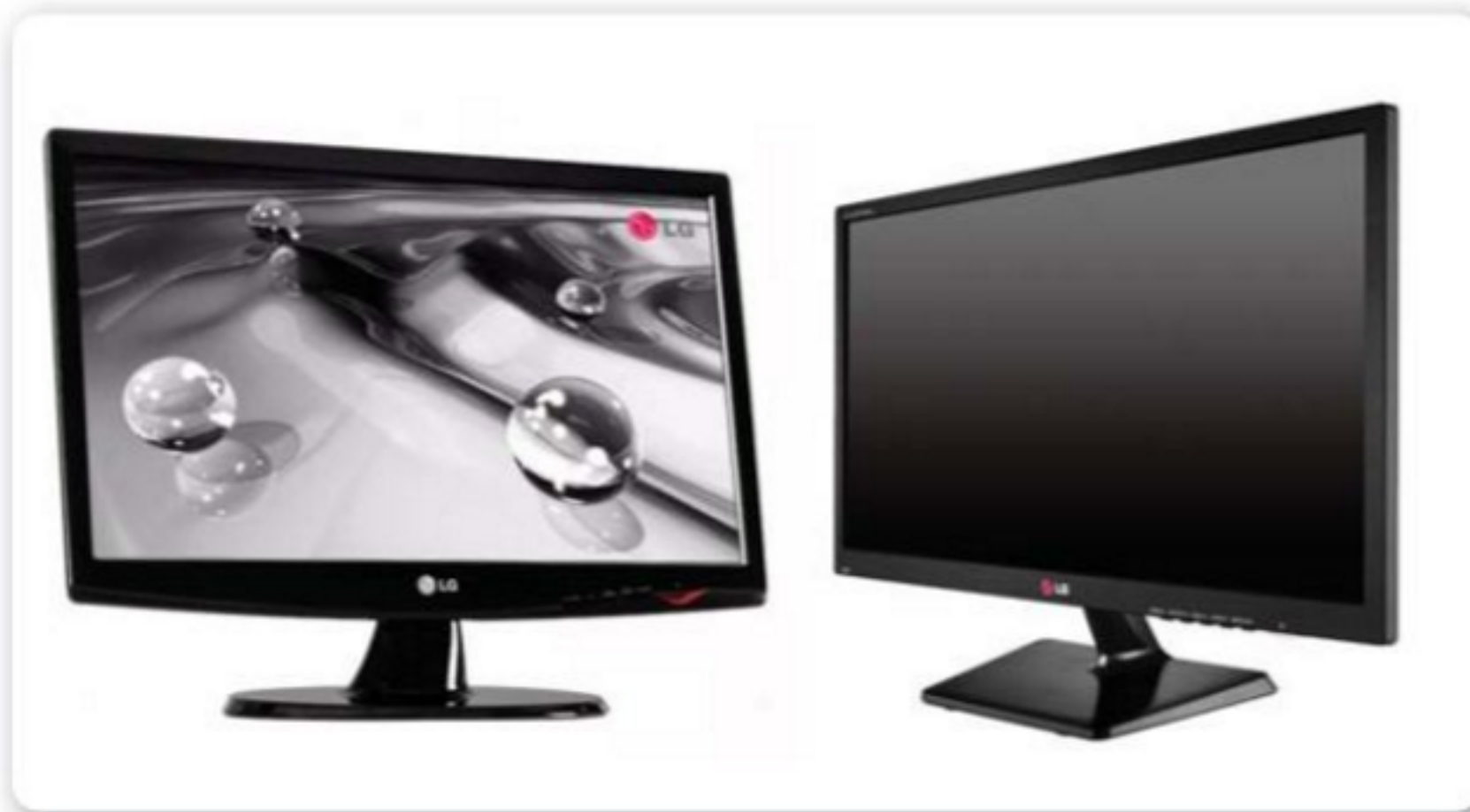
Figura 19. Un LCD frente a un monitor de LED. Este último, además de ser más fino, estéticamente, reduce el consumo eléctrico en 40%.
