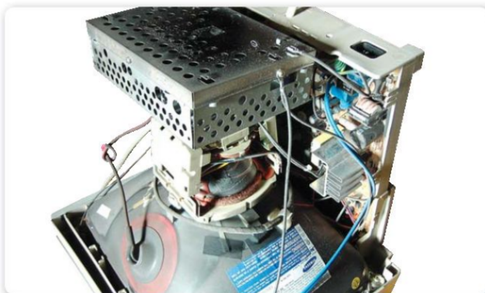
Figura 3. Así se ve un monitor CRT al quitarle la cubierta. Tengamos cuidado con los voltajes.
