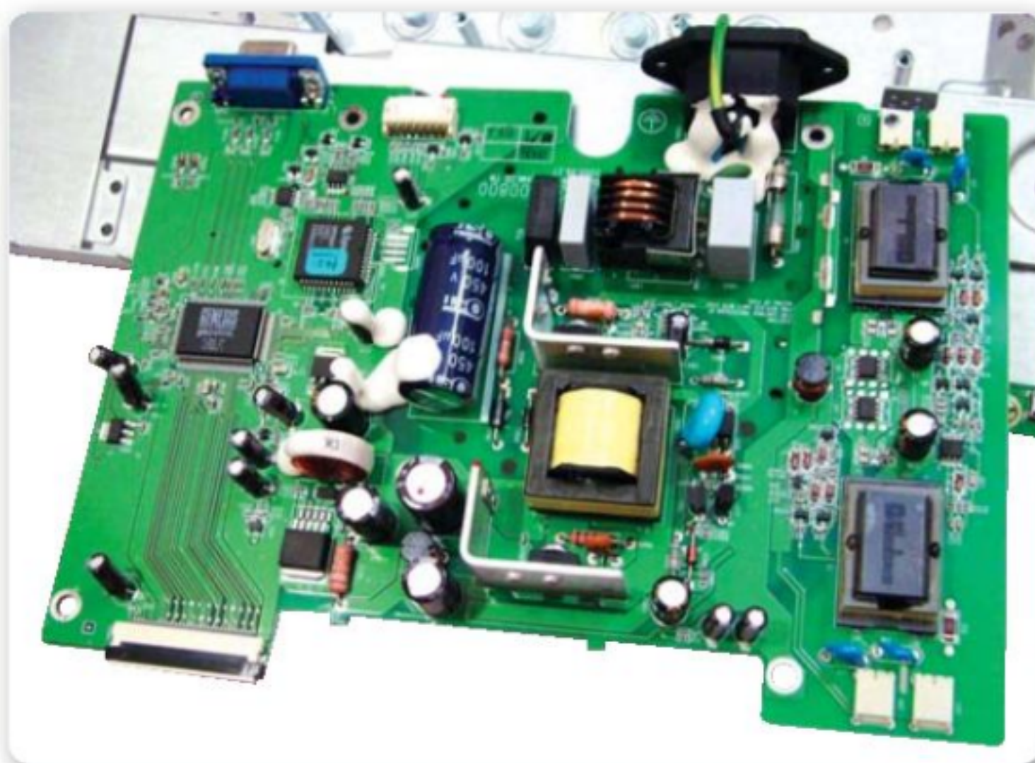
Figura 15. Detalle de la placa que corresponde a la fuente de poder del monitor CRT.
