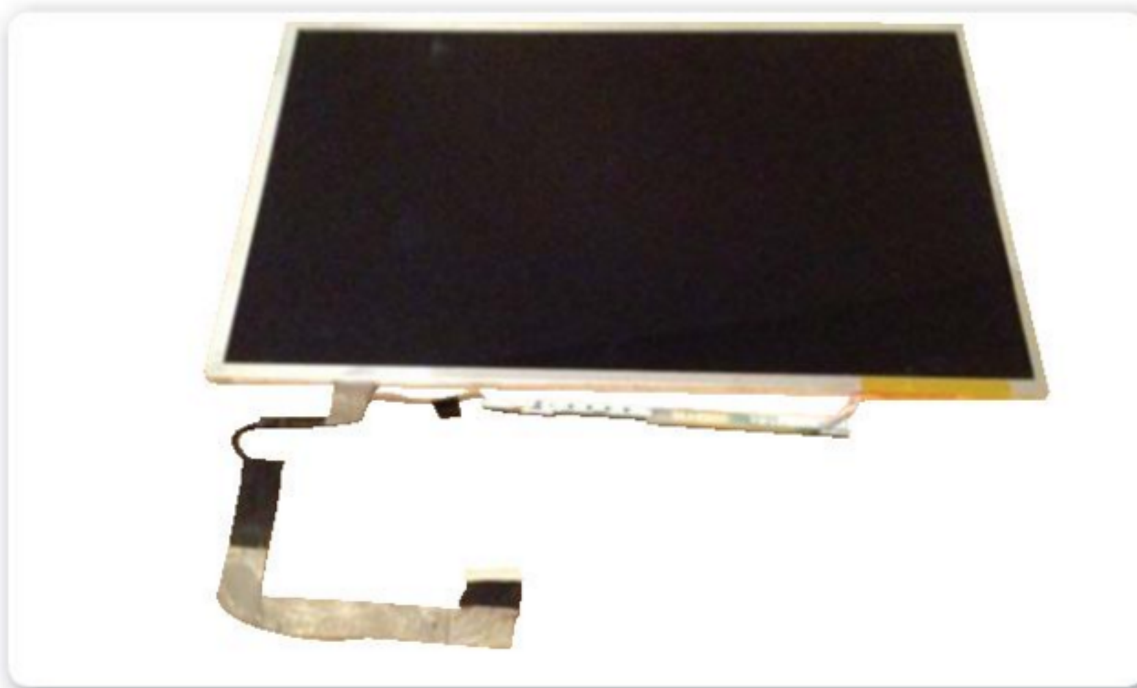
Figura 23. Los monitores LCD o de LED de notebook tienen el inverter integrado.
