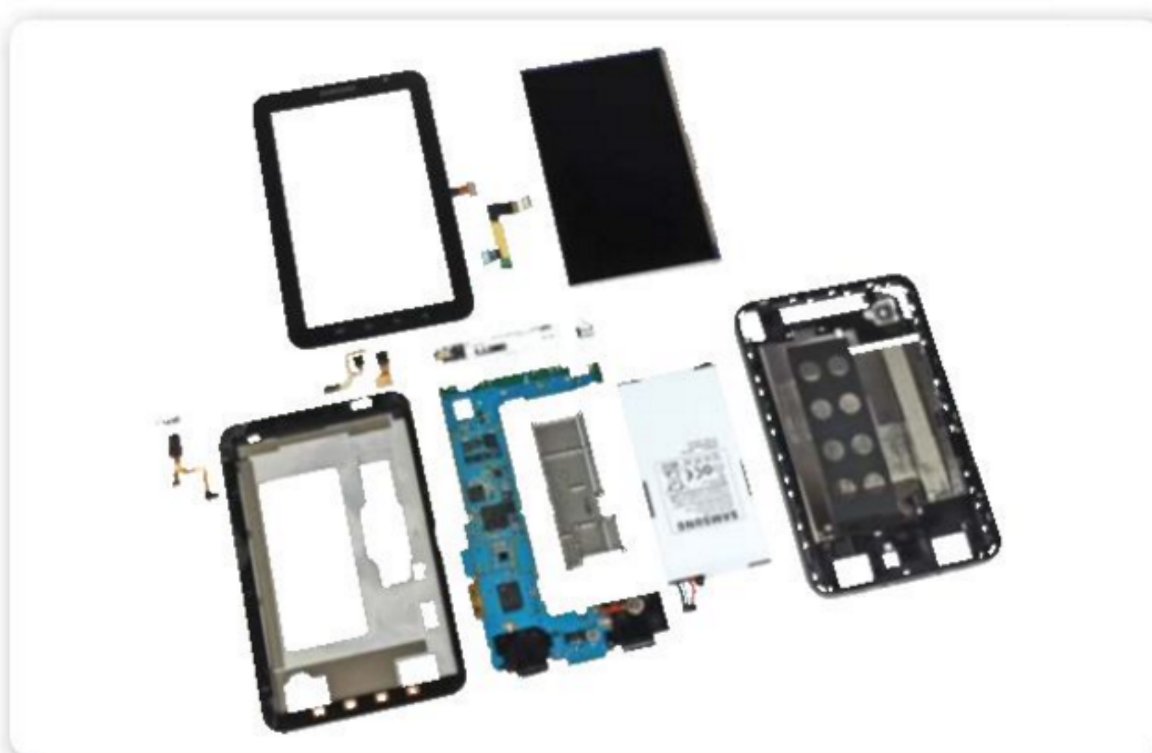
Figura 10. Aquí podemos observar el despiece de una GalaxyTab. Es similar a un smartphone.
