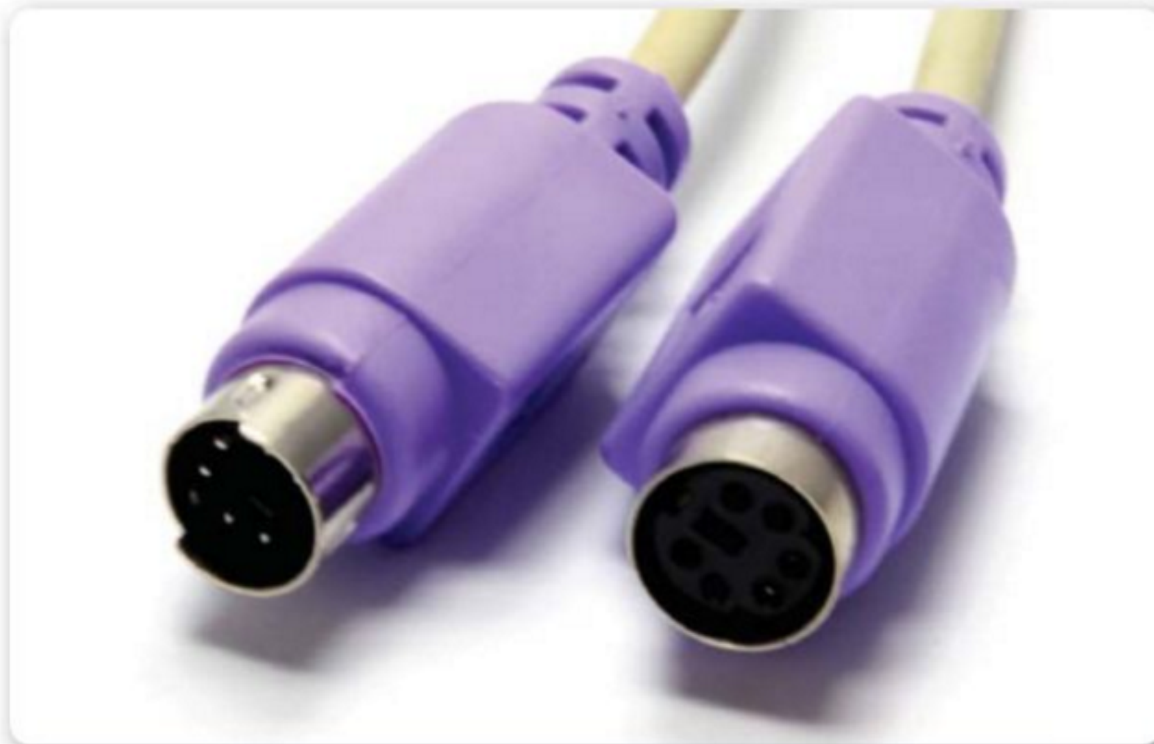
Figura 5. Conector PS/2 macho y hembra. Sus pines se suelen doblar al introducirlos de forma errónea, generando el mal funcionamiento de los periféricos.
