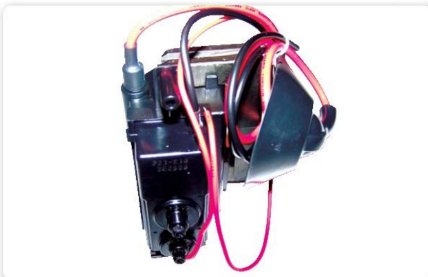
Figura 4. En la imagen vemos un flyback con la correspondiente sopapa que se adhiere al tubo.
